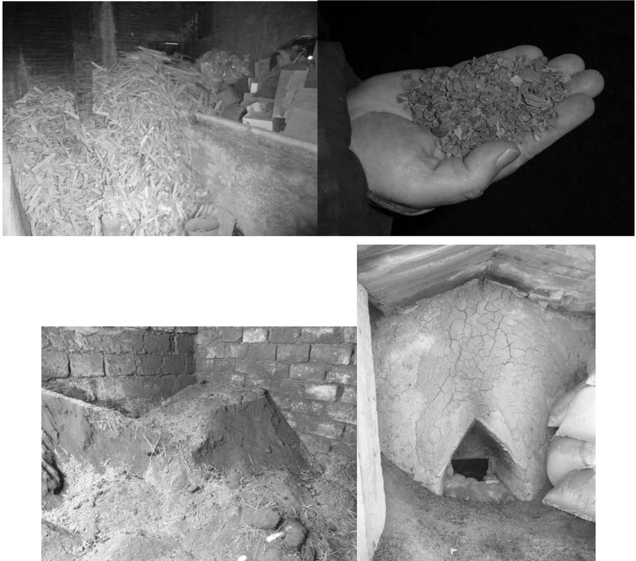
Fig. 24 Alcuni esempi di combustibile utilizzato per la cottura di ceramica e laterizi. A. cassette di legno e cortecce di alberi (Agóst); B. gusci di mandorle (Oliva); C. sansa (Racalmuto); D. sterco di pecore (Çömlekci).
