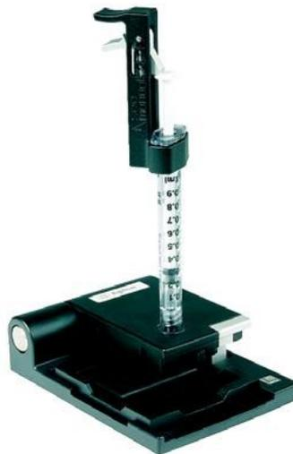
Figura 14: Prime station Agilent. La siringa spinge la *gel matrix* coniugata con il *dye* all'interno del chip.
