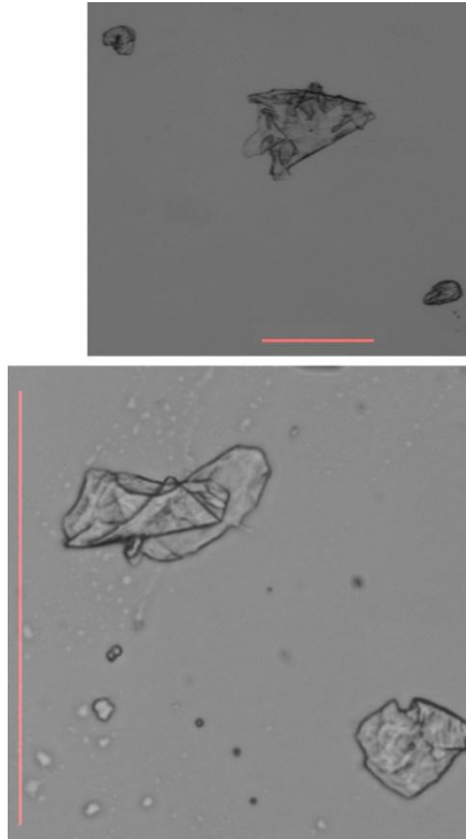
Figura 27. Analisi al microscopio ottico in contrasto di fase di Avidina+T8; bar: 100 \mu\text{m} .
