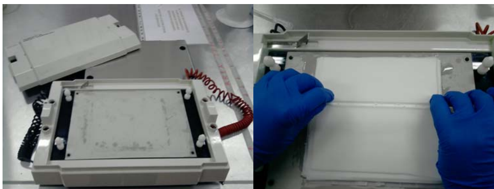
Fig. 23 Apparato per Western blot: trasferimento delle proteine dal gel di poliacrilammide alla nitrocellulosa e assemblaggio del sandwich.
