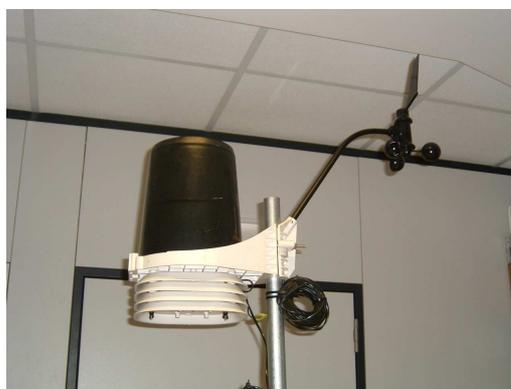
**Foto 3 - Dettaglio pluviometro e anemometro a coppe**
