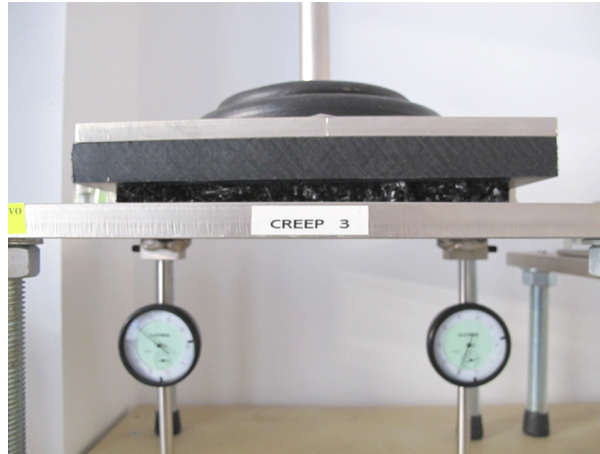
Figura 1.6: dispositivo per la rilevazione dei cedimenti nel tempo dei materiali utilizzati come sottofondi in pavimenti galleggianti.
