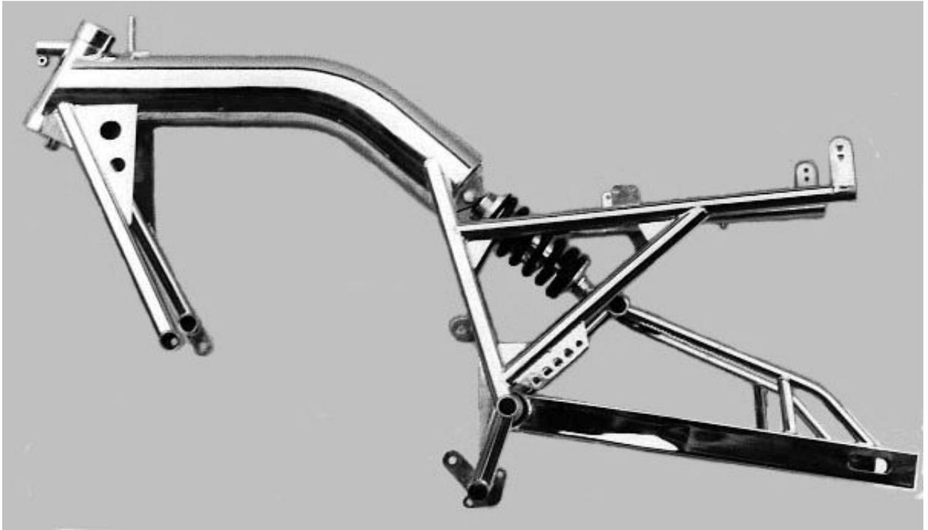
**Figura 3.4:** Esempio di sistema a monoammortizzatore, tipo cantilever
