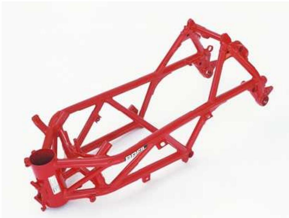
**Figura 5.3:** Telaio in traliccio di tubi
