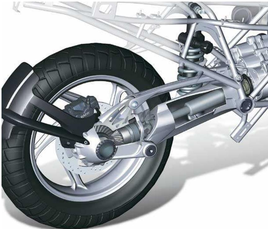
**Figura 3.23:** Soluzione a quadrilatero, trasmissione a cardano
