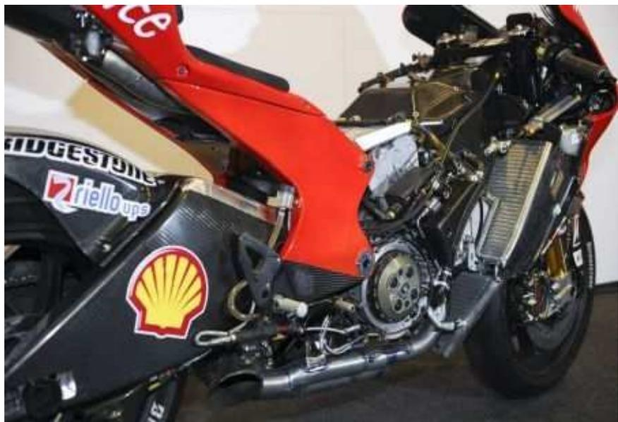
**Figura 5.2:** Telaio in carbonio
