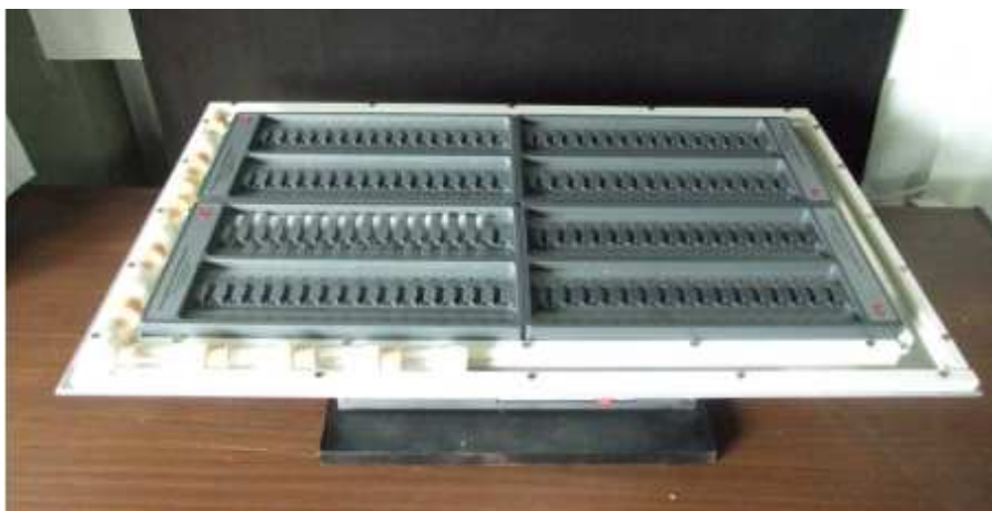
Fig. 6.1: Shift-work machine. I monitor, posizionati sull’oscillatore utilizzato per mimare “attività lavorativa” nelle mosche, permettono di registrare l’attività locomotoria di singole mosche. Il “lavoro” consiste nel recupero continuo di una situazione di equilibrio disturbato costantemente dallo stimolo meccanico trasmesso alle mosche.
