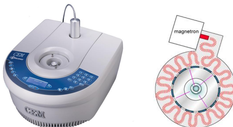
Figura 63. A sinistra: reattore monomodale self-tuning. A destra: sistema toroidale utilizzato per focalizzare le MW direttamente nel campione, presente al centro dello strumento.
