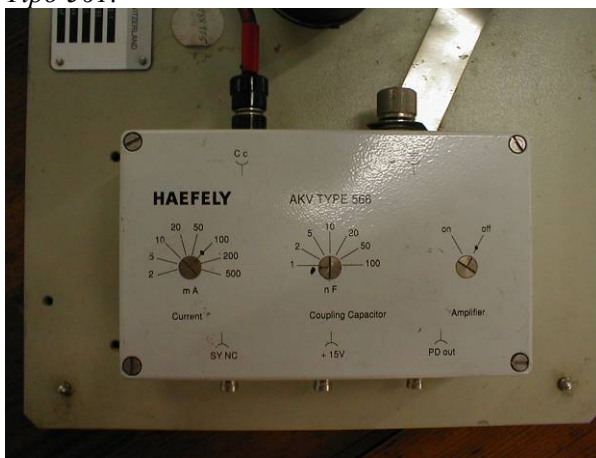
Figura 6-13: Quadripolo d'accoppiamento AKV 568 per strumento di misura Haefely Tipo 561.
