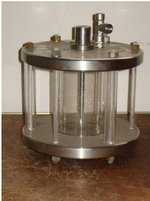
Figura 7-14: Provino in aria. Il provino è stato realizzato allo scopo di simulare il comportamento delle scariche parziali in gas.
