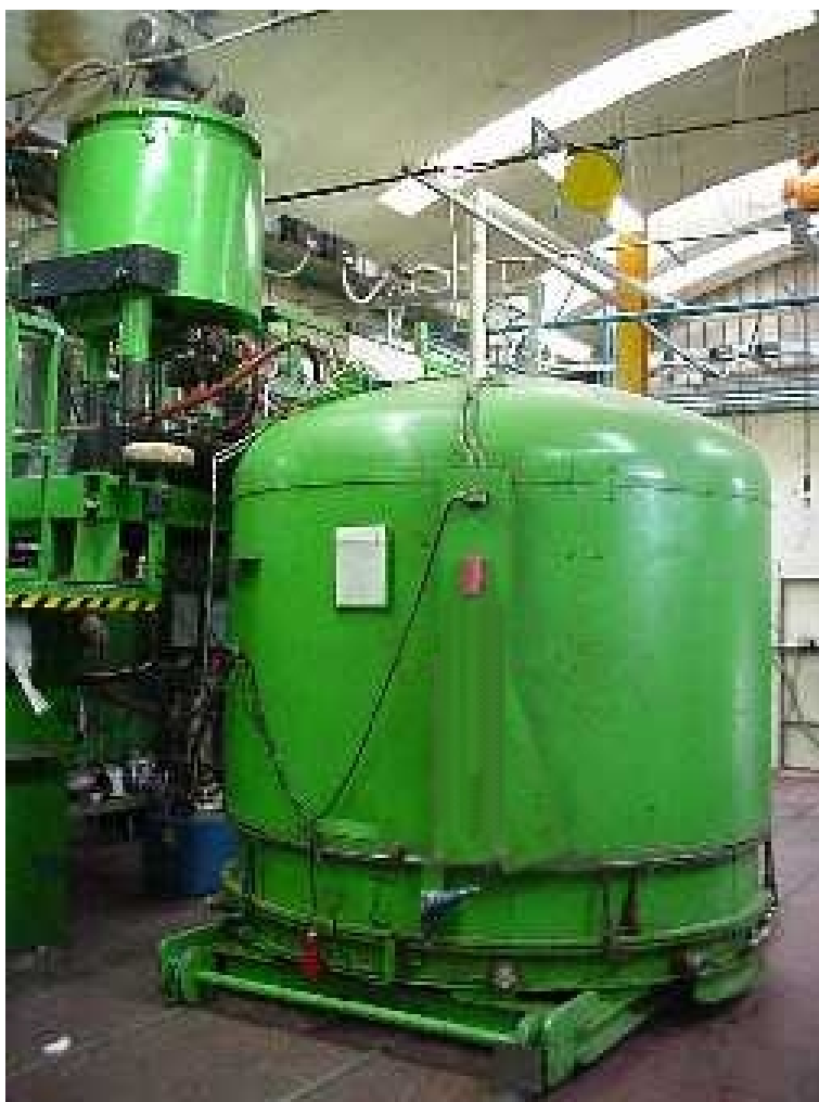
Figura 5-16: Impianto per la colata delle bobine in resina (TESAR)
