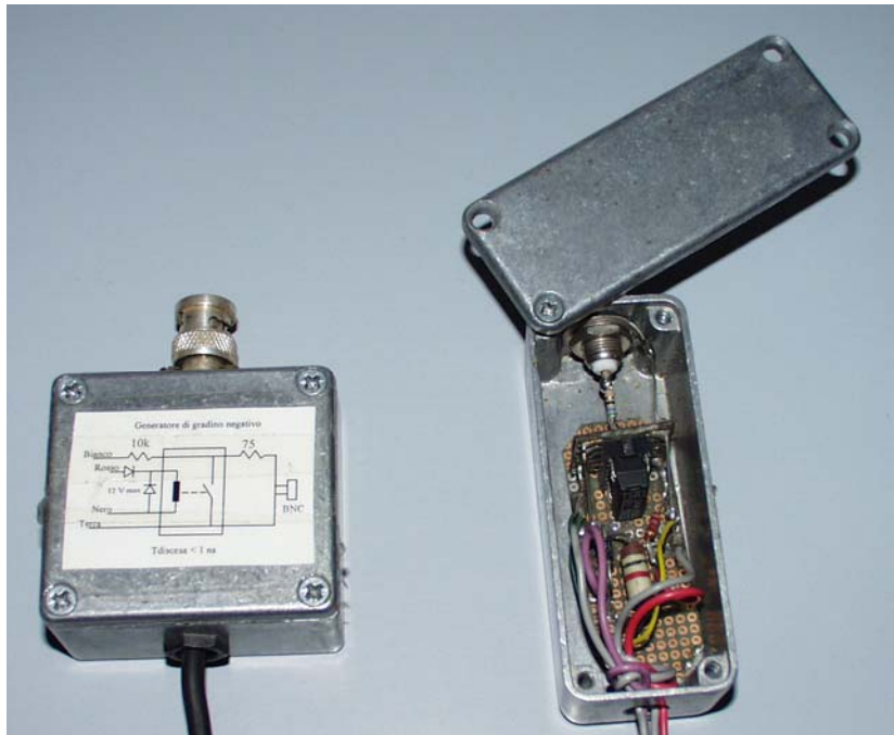
Figura 10-9: Calibratori, auto costruiti, utilizzati per il rilevamento delle funzioni di trasferimento della bobina.
