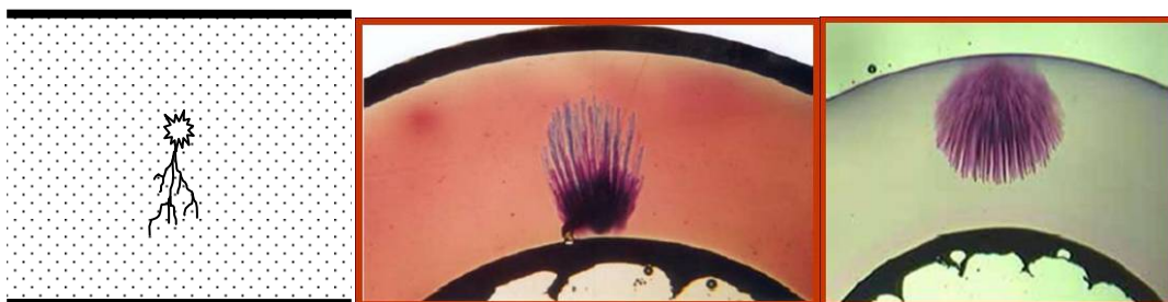
Figura 2-5: Esempio di “ electrical trees ” in cavi isolati in polietilene
