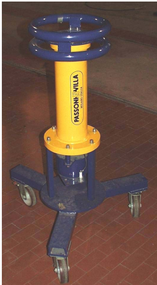
Figura 4-18: Condensatore isolato in carta olio di capacità nominale pari a 2 nF e tensione massima pari a 50 kV efficaci.
