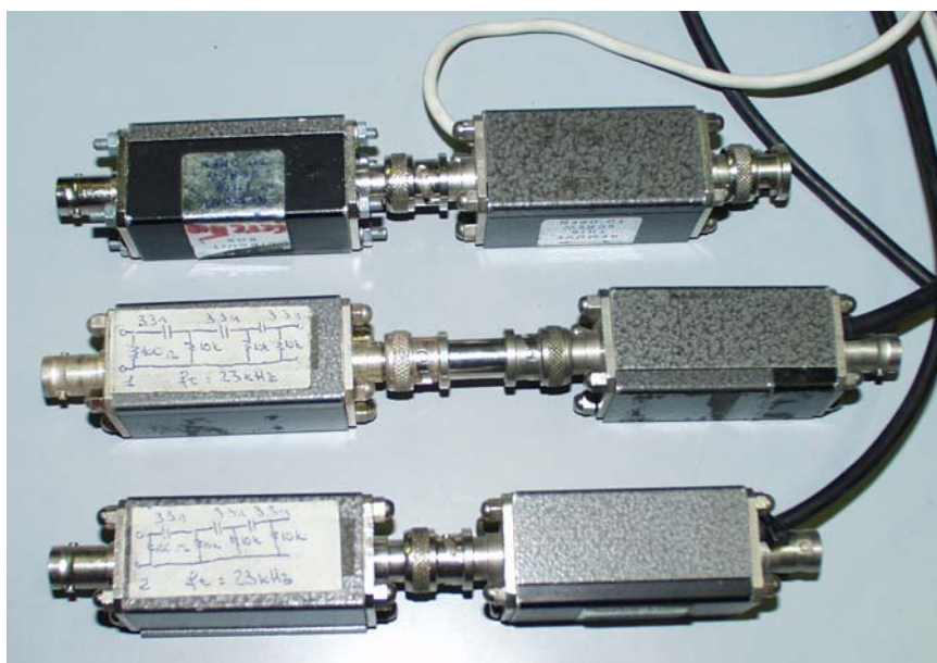
Figura 4-10: I tre filtri/impedenze di misura ed inseguitori di tensione realizzati.
