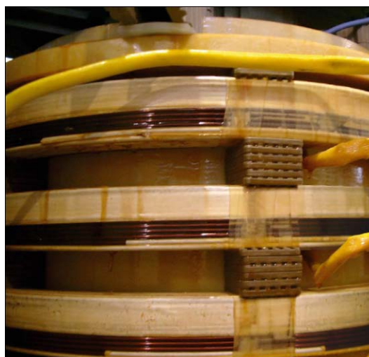
Figura 5-8: Avvolgimento realizzato in sezioni o cellette a filo (SEA)
