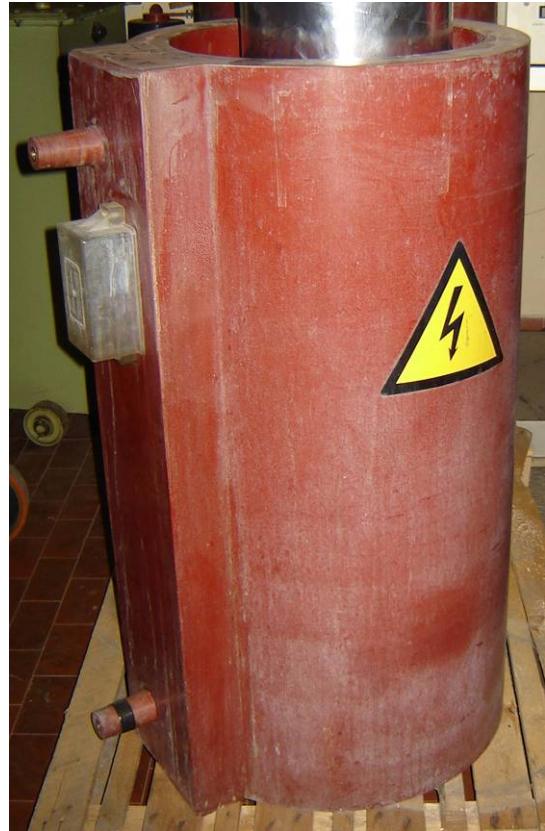
Figura 10-8 Bobina di media tensione appartenente ad un trasformatore da 1250 kVA – 30 kV.
