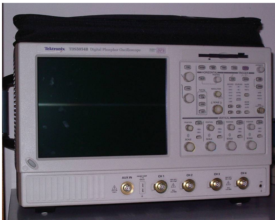
Figura 4-8: Oscilloscopio Tektronix TDS 5054B utilizzato nel sistema di misura auto costruito.
