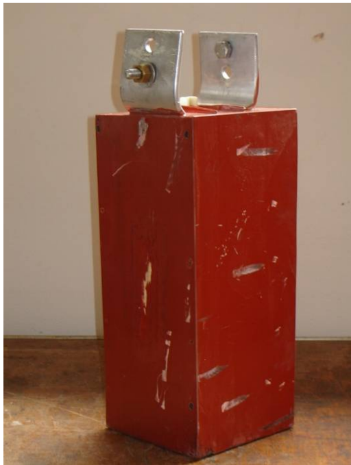
Figura 7-22: Provino in resina. Tale provino è stato realizzato allo scopo di simulare la configurazione di campo presente all'interno di una bobina di media tensione in resina epossidica. Il provino è affetto da scariche parziali di tipo interno.
