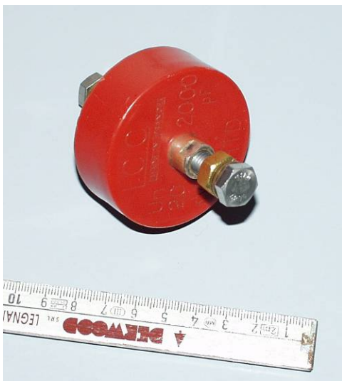
Figura 4-17: Condensatore ceramico di capacità nominale pari a 2 nF e tensione massima pari a 20 kV efficaci.
