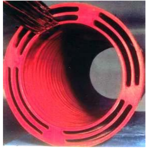
Figura 5-14: Avvolgimento di bassa tensione inglobato in resina. (Campi elettrici limitati e dunque possibilità di realizzazione dei canali di raffreddamento)
