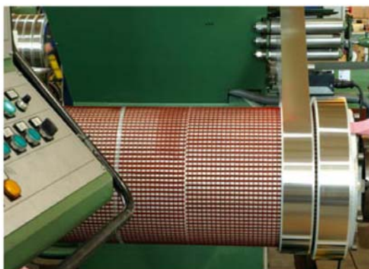
Figura 5-9: Realizzazione di un avvolgimento di media tensione in sezioni o cellette in lastra di alluminio. (Costruzione SEA)
