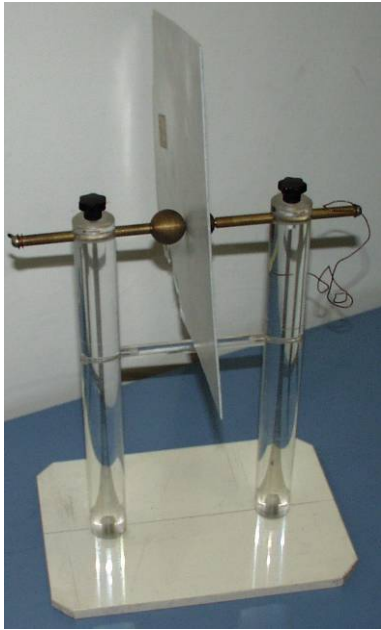
Figura 7-18: Provino in aria-teflon. Il provino è stato realizzato allo scopo di simulare il comportamento delle scariche parziali di tipo superficiale.
