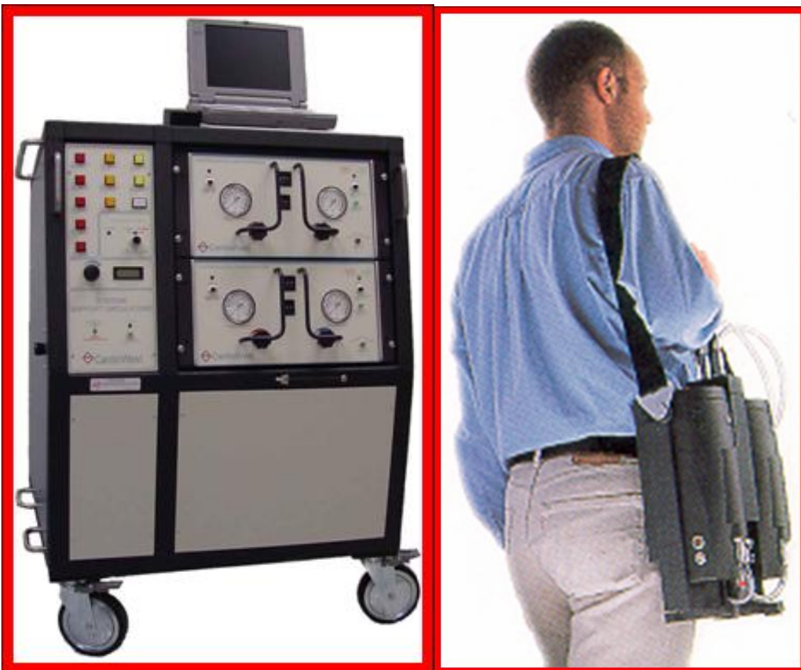
Fig 41: la drive pneumatica fissa del Cardiowest, accanto quella portatile.
