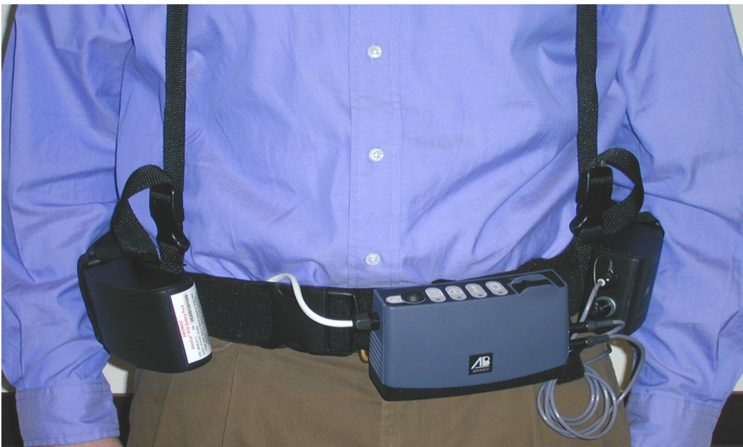
Fig 44: Il sistema Abiocor 1 TAH e tutte le sue componenti esterne.
