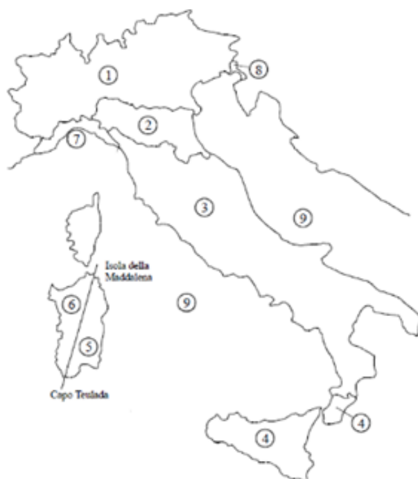
Fig. 4. Zone di carico vento (NTC 2008, p. 27).
