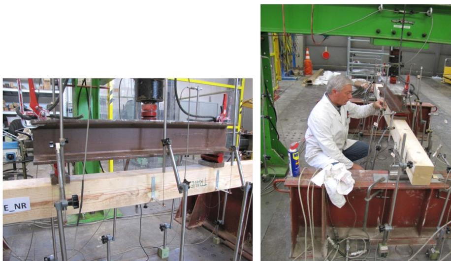
*Figura 7.10: Preparazione della trave per la prova.*
