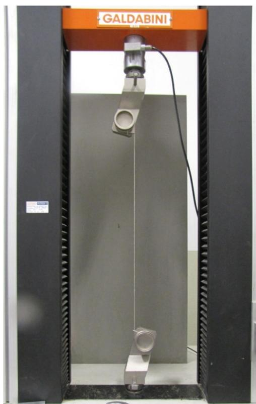
*Figura 5.1: Set up di prova per la trazione di singoli fili di lino.*
