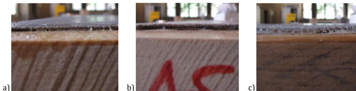
Figura 4.9: Spessori dei materiali compositi con (a) 3 strati, (b) 4 strati e (c) 5 strati di fibra.
