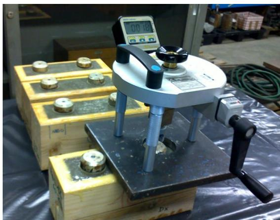
Figura 6.3: Set up di prova per il test di pull-off.
