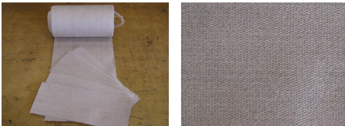
Figura 3.6: Fibra di lino FIDFLAX, utilizzata nella sperimentazione.
