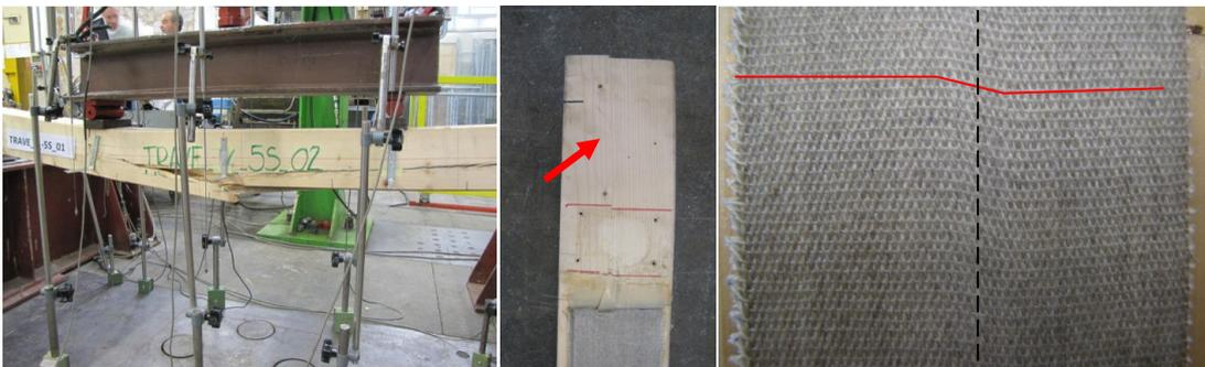
Figura 7.29: Rottura della trave per collasso delle fibre in zona tesa e lo scorrimento reciproco.
