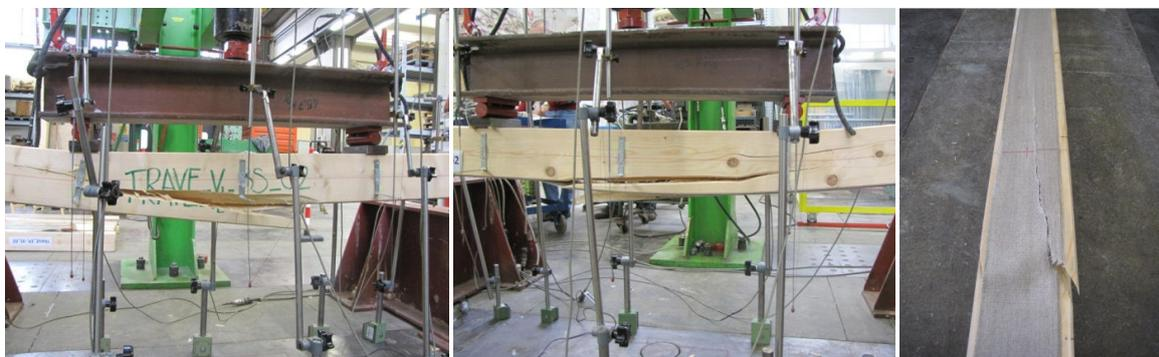
Figura 7.23: Rottura della trave per collasso delle fibre in zona tesa.
