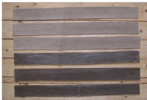
Figura 5.12: Alcuni campioni asciugati (i più chiari sono FFRP(V) e quelli più scuri FFRP).
