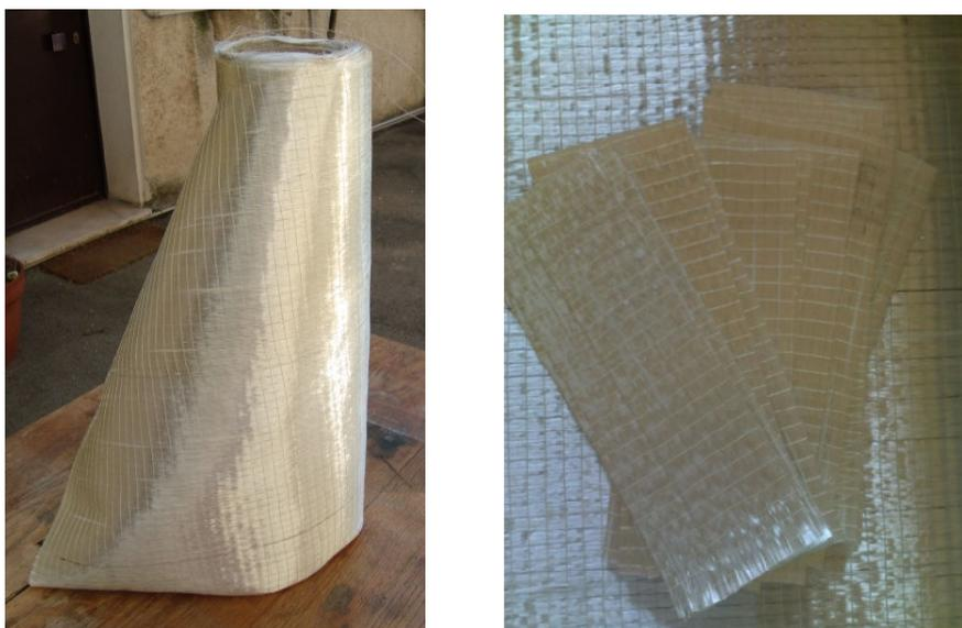
Figura 3.3: Fibra di vetro MBrace, utilizzata nella sperimentazione.
