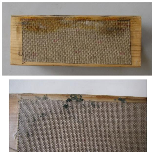
Figura 6.27: Presenza di muffe sia sul legno, sia sul composito.
