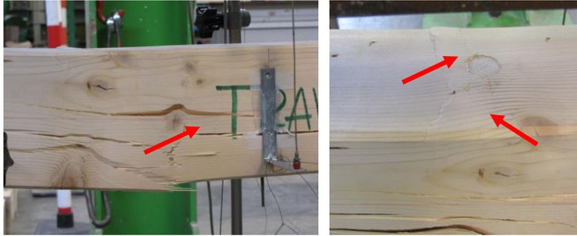
Figura 7.17: Frattura del legno in zona tesa e compressa.
