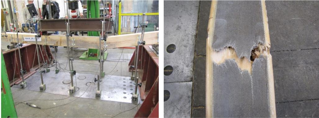
*Figura 7.31: Rottura della trave per collasso delle fibre.*
