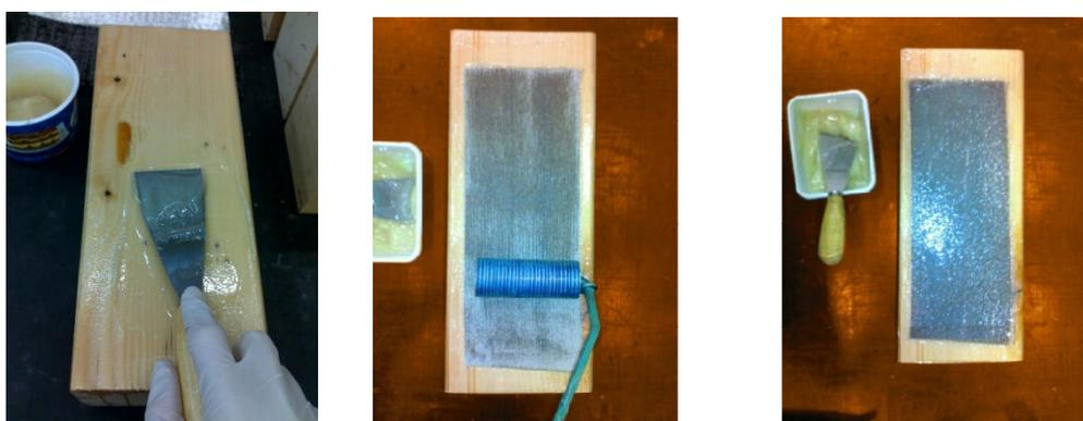
*Figura 4.8:* Realizzazione di un campione rinforzato con FRP (resina epossidica).
