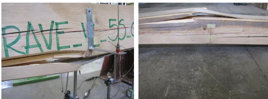
*Figura 7.27: Scollamento del composito FFRP(V) - 5 strati dal punto di rottura del legno.*
