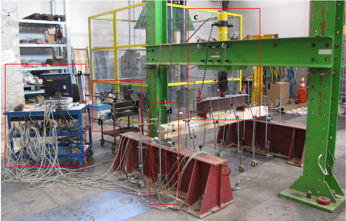
Figura 7.11: (a) sistema di acquisizione; (b) pompa idraulica; (c) martinetto idraulico con cella di carico e putrella; (d) trasduttori induttivi di spostamento.
