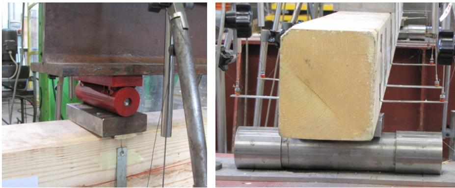
*Figura 7.8:* Appoggi cilindrici.
