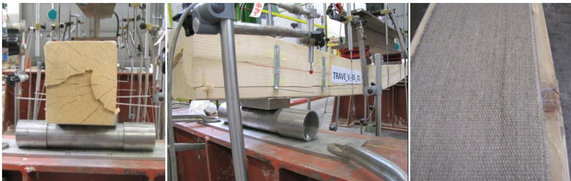
Figura 7.21: Rottura della trave per scorrimento reciproco delle fibre del legno.
