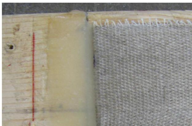
*Figura 7.4:* Rastrematura con resina epossidica alle estremità del rinforzo con composito naturale.
