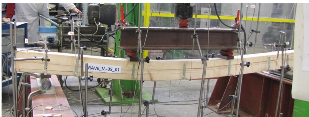
Figura 7.19: Forte flessione della trave in prossimità del carico di rottura.
