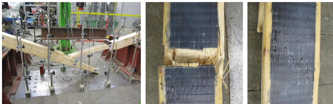
Figura 7.42: Rottura per spaccatura netta del legno in corrispondenza degli appoggi.
