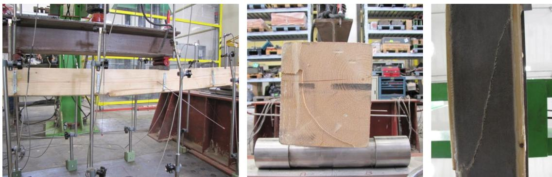
Figura 7.34: Rottura della trave per collasso delle fibre.
