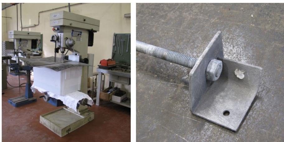
*Figura 4.14:* Strumentazione adottata per tenere costantemente movimentata la soluzione alcalina.
