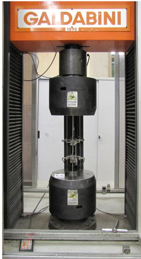
*Figura 5.16: Set up di prova per la trazione delle strisce di FRP.*
