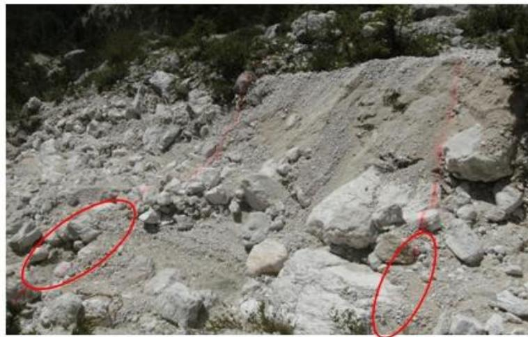
**Fig. 4-5: sezioni monitorare con evidenza di trasporto di fondo, evidenziato dall'asportazione della linea di marcatura colorata (cerchi rossi).**
