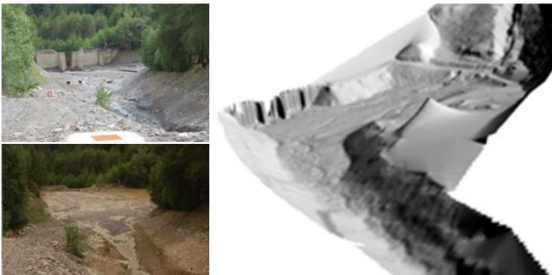
**Fig. 3-7: piazza di deposito del torrente Gadria pre e post evento 2010. Sulla sinistra l'hillshade del modello digitale del terreno della piazza di deposito e della briglia. Si noti sulla destra il torrente Strimm, che va a confluenza in piazza di deposito.**
