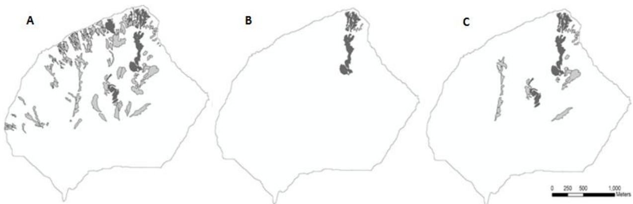
**Fig. 5-6: attivazione delle aree sorgente di sedimento per eventi di elevata (A), bassa (B) e media (C) magnitudo. Il colore grigio scuro indica le aree sorgente tra le prime 10 del ranking MPI, il grigio chiaro tutte le altre.**
