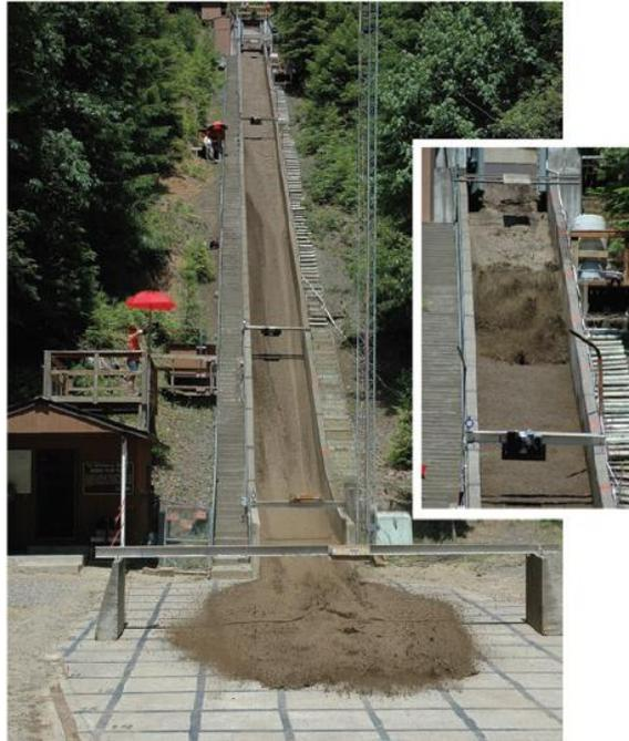
Fig. 1-5: modello fisico a fondo mobile a grande scala USGS (Iverson et al, 2011).
