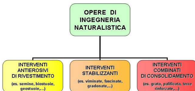
Figura 4 Interventi dell'ingegneria naturalistica
