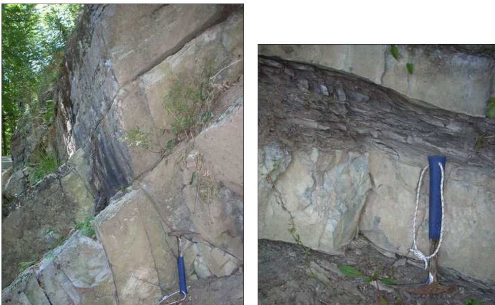
Figura 5.3 - Affioramento di Calccare di Angolo (sinistra) e di Calccare di Prezzo (destra) nell'area studio.
