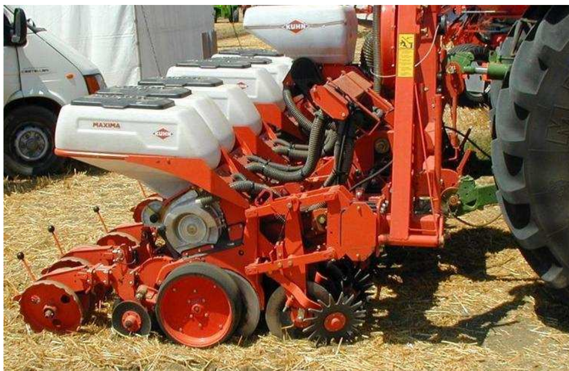
Fig. 17 – Presenza di un utensile spartitore anteposto al disco preparatore in una seminatrice di precisione con assolcatore a doppio disco.
