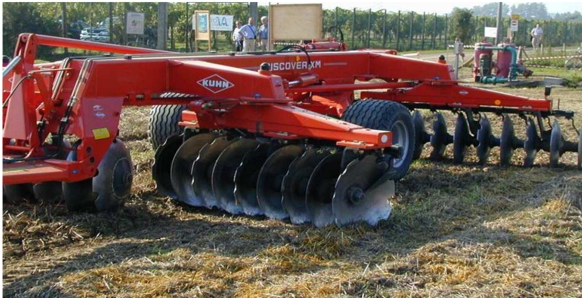
Fig. 15 – Erpice a dischi tandem che presenta in modo alternato dischi lisci e dentati.
