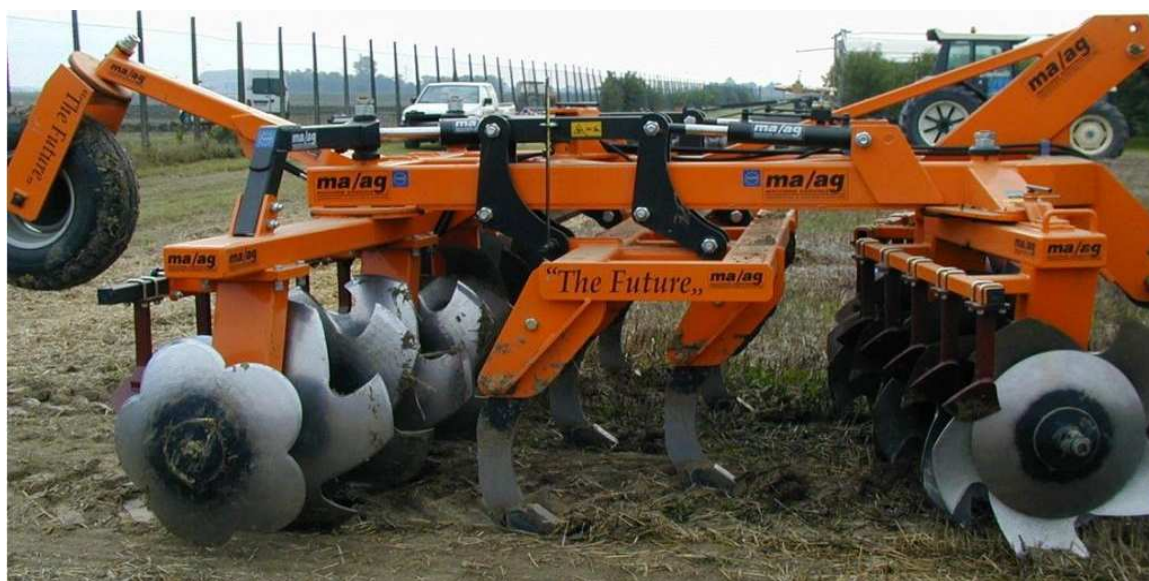
Fig. 13 – I dischi anteriori sono in grado di avere una buona penetrazione anche in terreni duri, quelli posteriori frantumano le zolle e miscelano il residuo. Le ancore decompattano il terreno.
