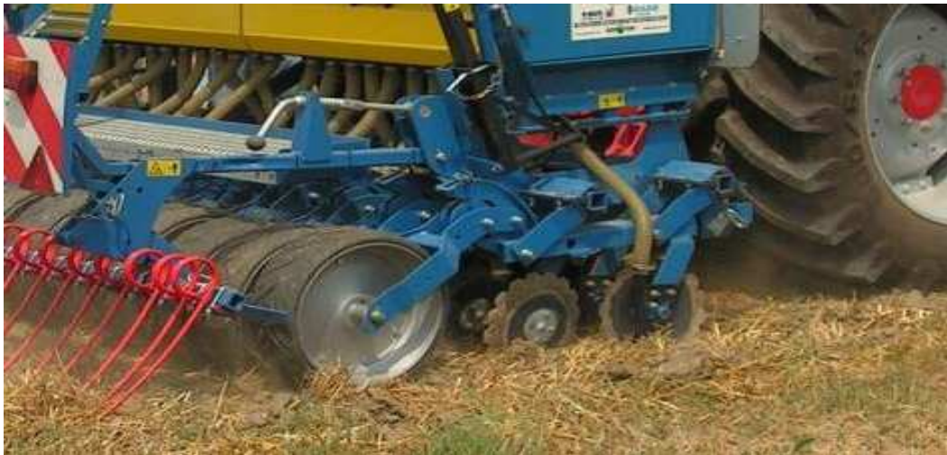
Fig. 18 – Seminatrice a righe con assolcatore a disco singolo e chiudi solco gommato.
