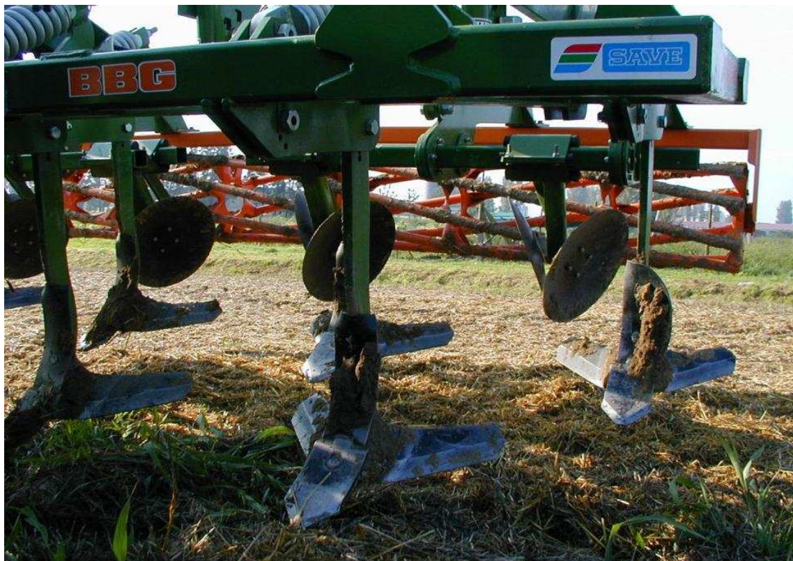
Fig. 10 – Particolare conformazione della parte terminale dell'ancora di un coltivatore.
