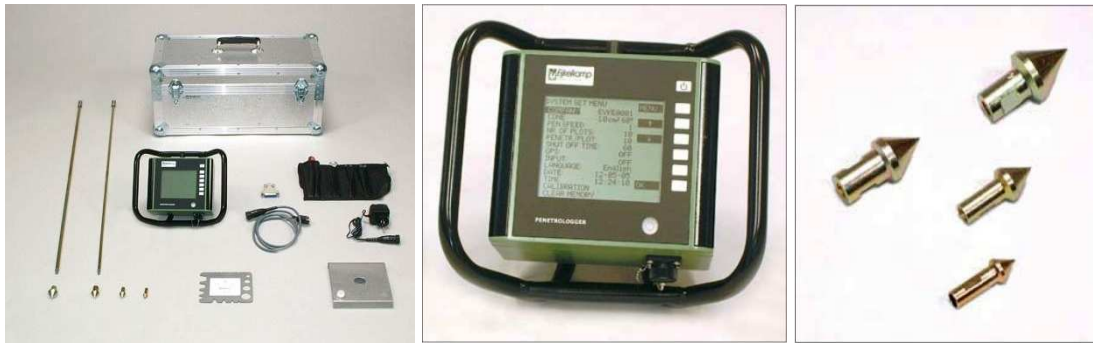
Fig. 31 – Particolari del Penetrometro Eijkelkamp Penetrologger
