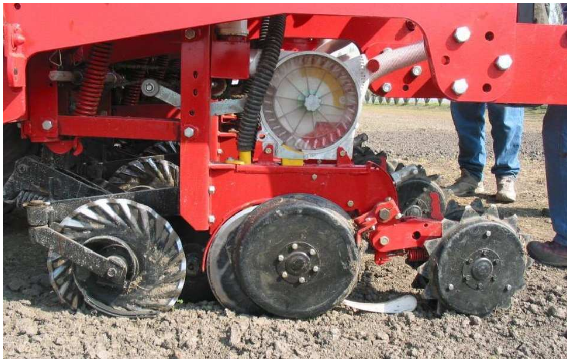
Fig. 16 – L'elemento di semina è composto da un disco preparatore, un assolcatore a doppio disco con ruote di profondità in metallo e ruote chiudi solco.
