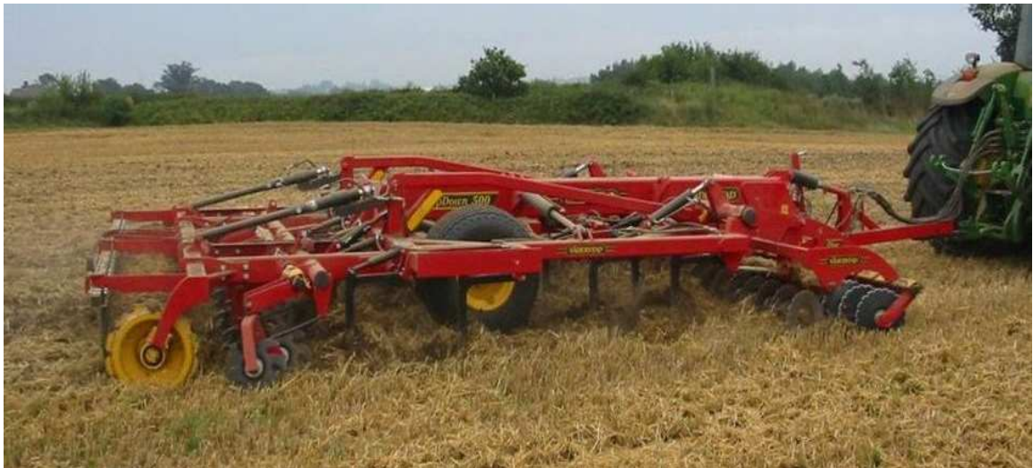
Fig. 14 – Attrezzatura che lavora in superficie e lascia il terreno in condizioni idonee alla semina.
