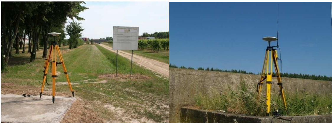
Fig. 32 – Le aree di saggio sono state georeferenziate mediante GPS con correzione differenziale RTK
