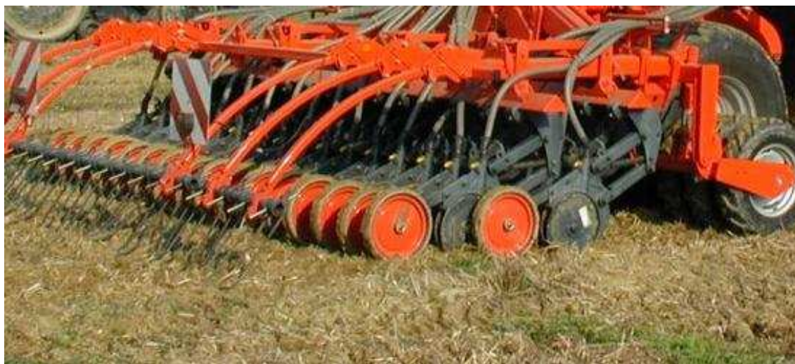
Fig. 20 – In questa seminatrice a righe, dopo l'assolcatore a doppio disco segue un piccolo disco convesso in metallo che effettua una prima chiusura del solco seguita da una ruota con profilo gommato munita di elemento raschia fango.
