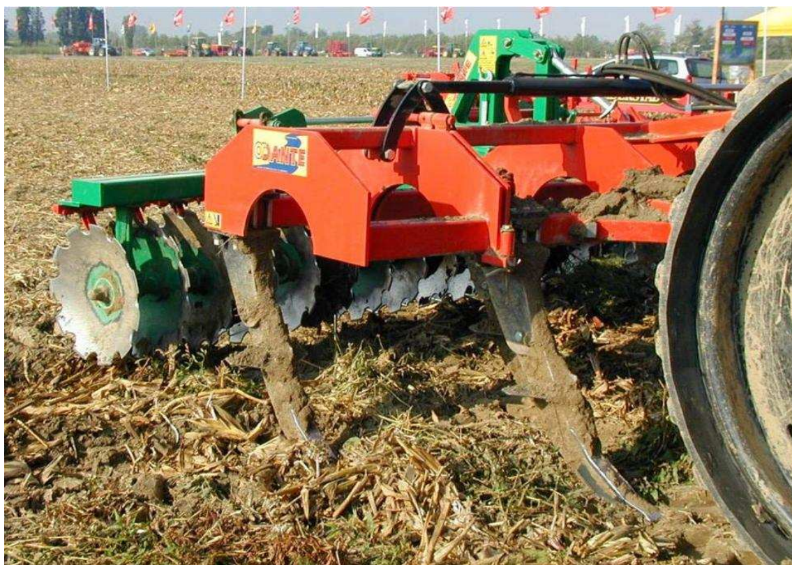
Fig. 11 – Esempio di coltivatore pesante equipaggiato con ancore inclinate in avanti. Il rullo a dischi concavi dentati posteriore svolge un'energica azione di rottura delle zolle.
