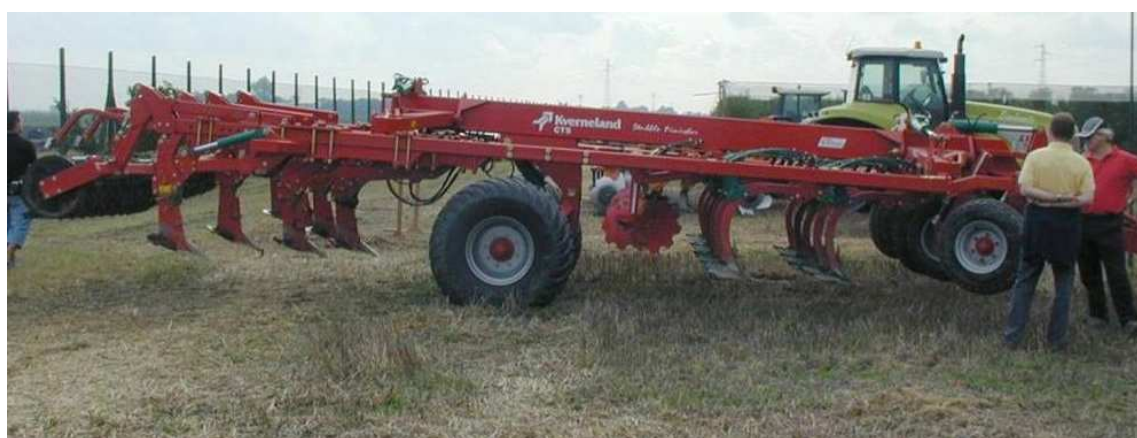
Fig. 12 – Esempio di una grande attrezzatura combinata composta da sequenze di utensili diversi.
