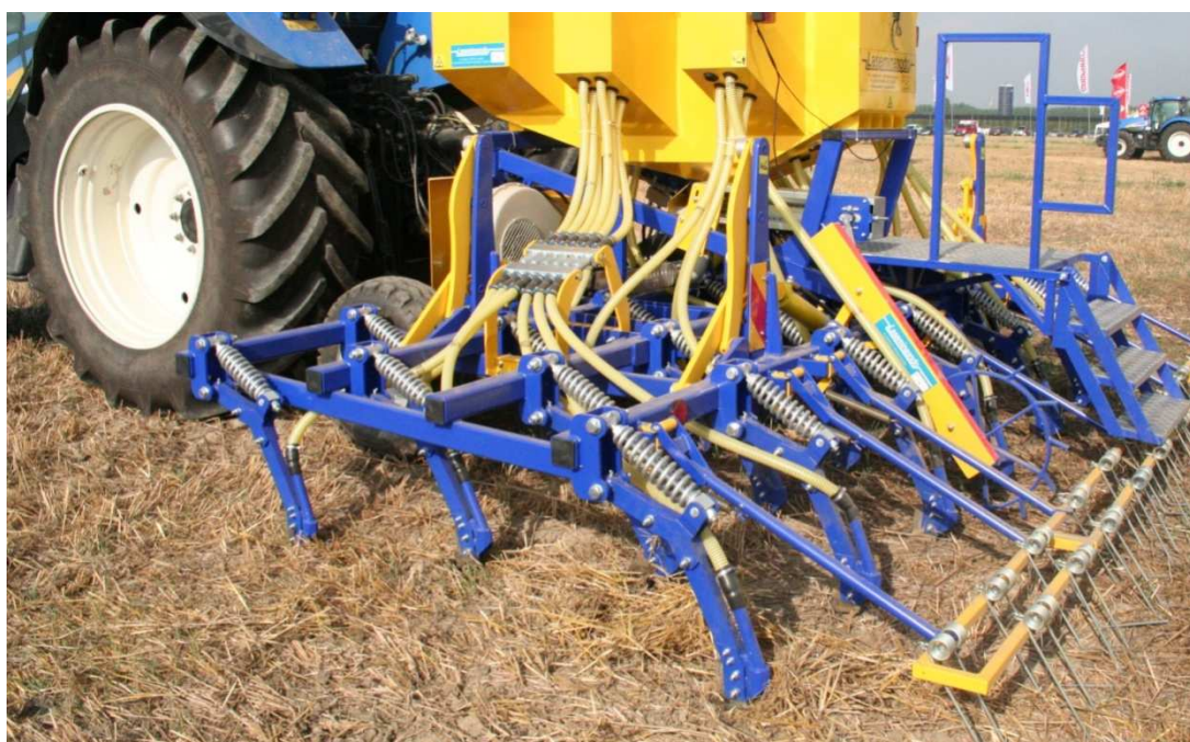
Fig. 19 – Seminatrice a righe con assolcatori ad ancora disposti su più ranghi.
