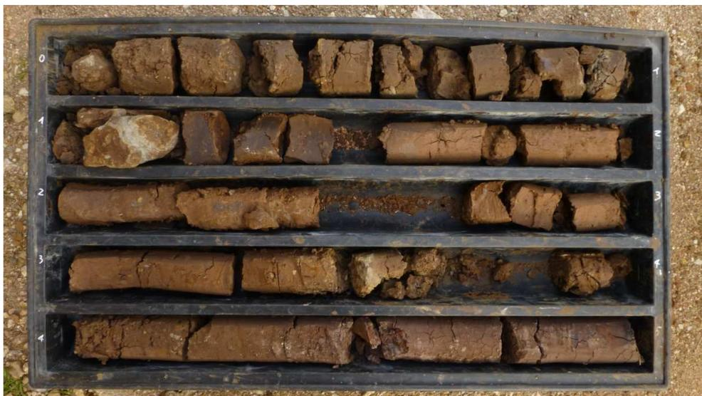
Figura 13 Carotaggio da 0 a 5 metri (dall'alto verso il basso)
