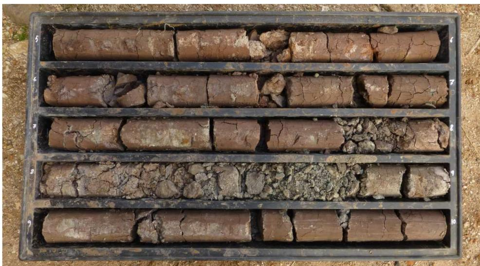
Figura 14 Carotaggio da 5 a 10 metri (dall'alto verso il basso)
