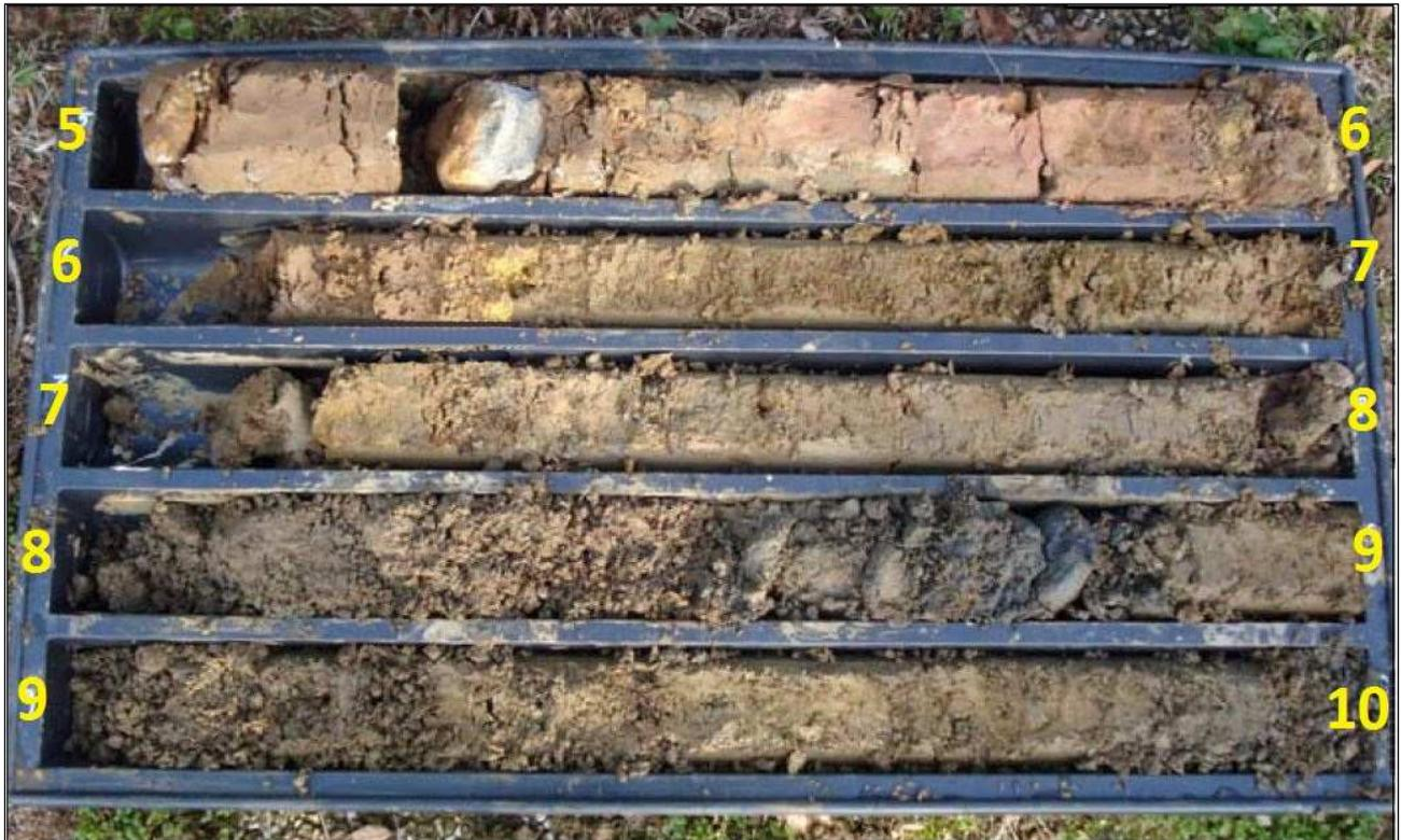
Figura 10 Cassetta catalogatrice relativa alla porzione profonda del sondaggio.
