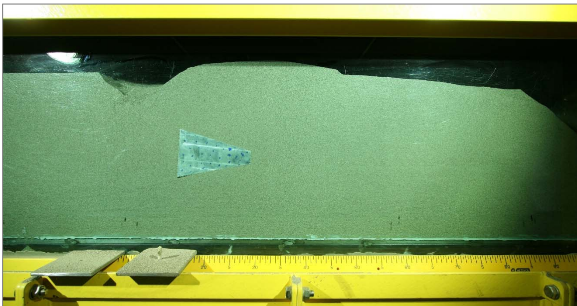
Figura 4.69. Modalità A, piastra conica lunga, P1: posizione del sistema flottante a fine estrazione.
