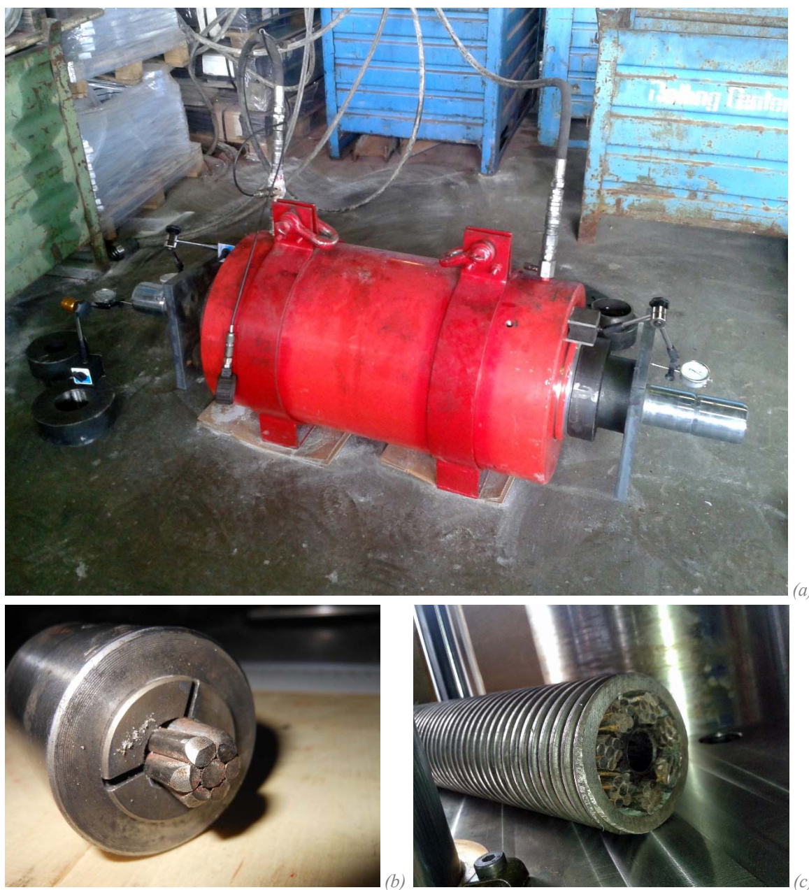
Figura 3.9. Prove di trazione su barre composite: martinetto e dispositivi di controllo delle deformazioni (a), cuneo di blocco per trefolo (b), barre di ancoraggio composite con centratore (c).
