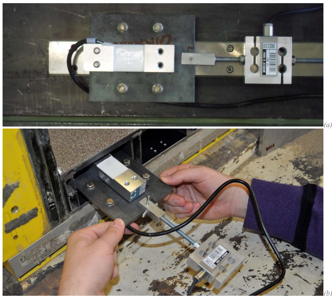
Figura 4.4. Carrello e celle di carico: vista dall'alto (a) e operazione di inserimento (b).
