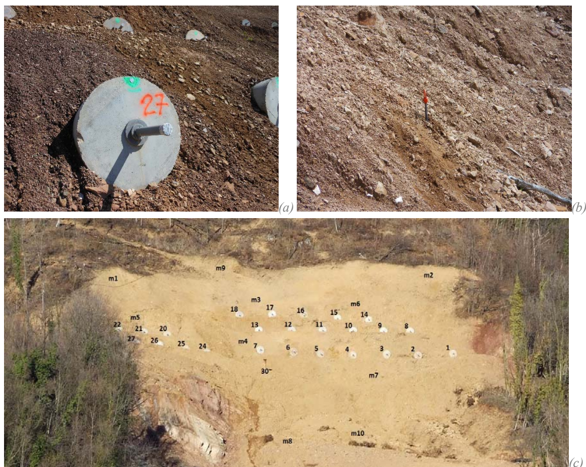
Figura 7.25. Frana di Val Maso: mire per il monitoraggio topografico sulle piastre flottanti (a), sul corpo frana (b) e vista d'insieme (c).
