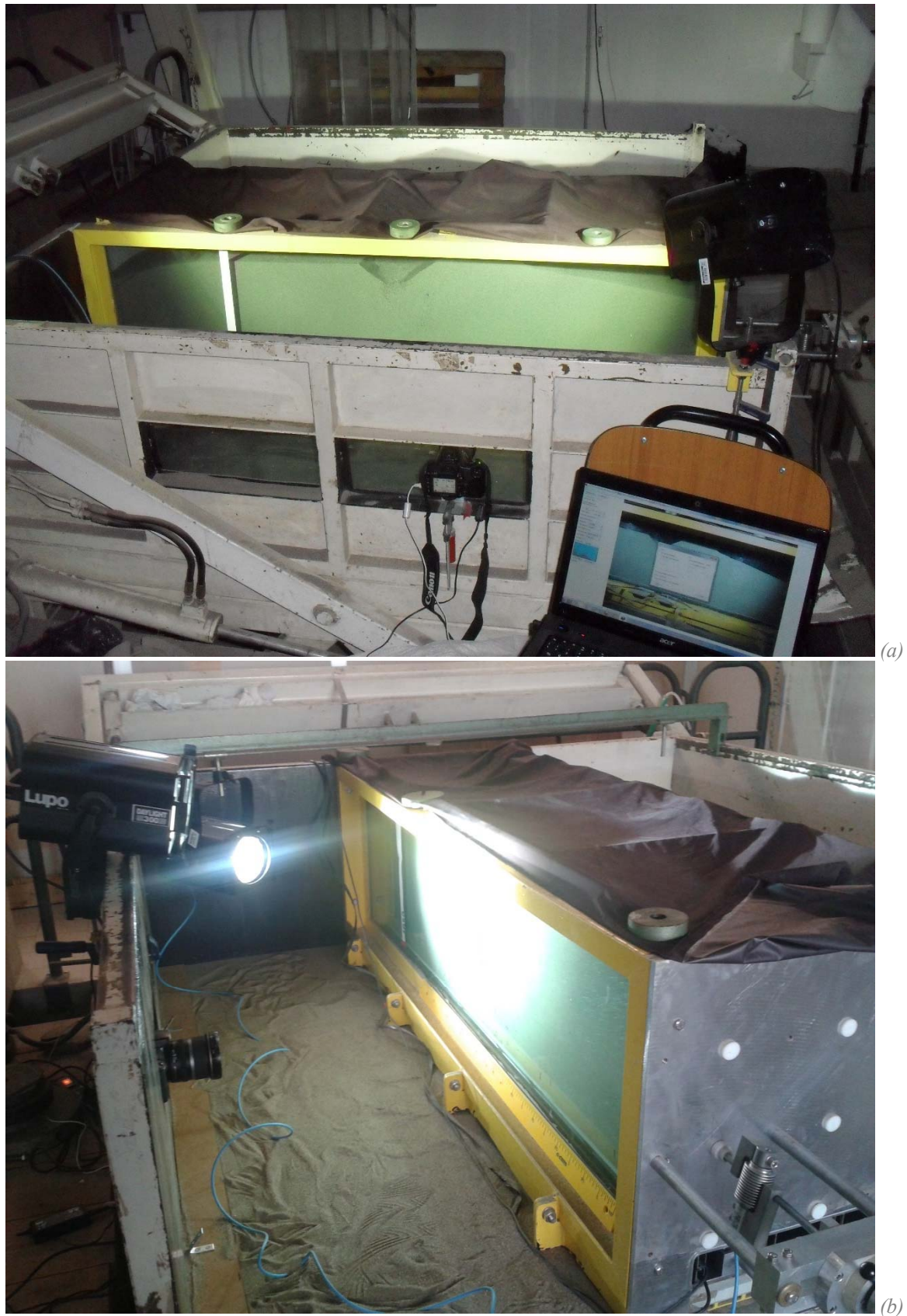
Figura 4.16. Disposizione dell'attrezzatura in fase di prova: particolare del posizionamento della macchina fotografica (a) e della modalità di illuminazione (b).
