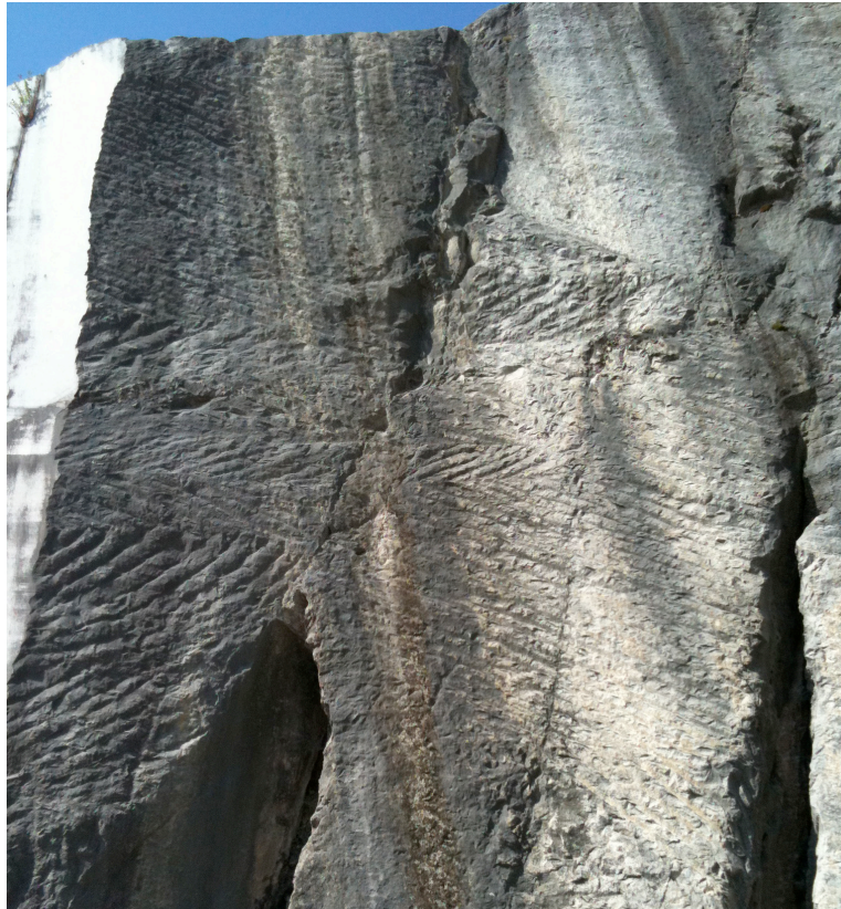
Fig. 7 - Segni di estrazione manuale
