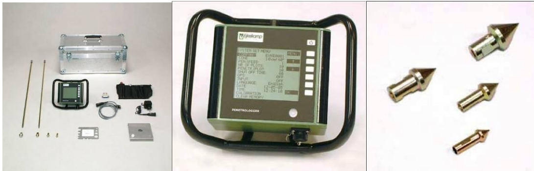
Figura 3.13. Immagini delle varie componenti del penetrometro (datalogger, punte).
