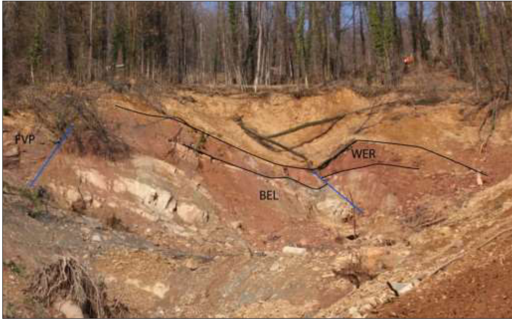
Figura 67. Vista della scarpata principale di frana, con esposizione del contatto tra la Formazione di Werfen (WER) e la Formazione di Bellerophon (BEL); Entrambe in contatto tettonico a sinistra con le Filladi di Valli del Pasubio (FVP). Sopra tali formazioni si nota il deposito detritico coinvolto nel dissesto di Val Maso, con spessore maggiore al centro.
