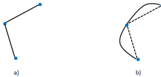
Figura 5.9: Differenza tra percorso spezzato (distanza euclidea, a ) e percorso a spline (distanza generalizzata, b ), per lo stesso set di punti.
