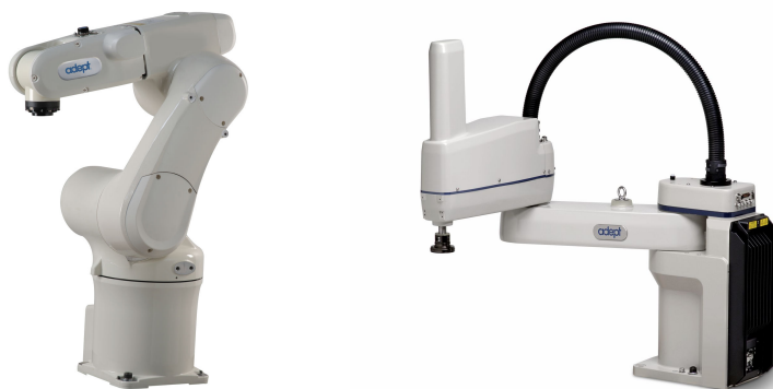
Figura 1.4: Esempi di manipolatori industriali. Robot a 6 assi Adept Viper s650 (sinistra) e robot a 4 assi Adept Cobra s800 di tipologia SCARA (destra).
