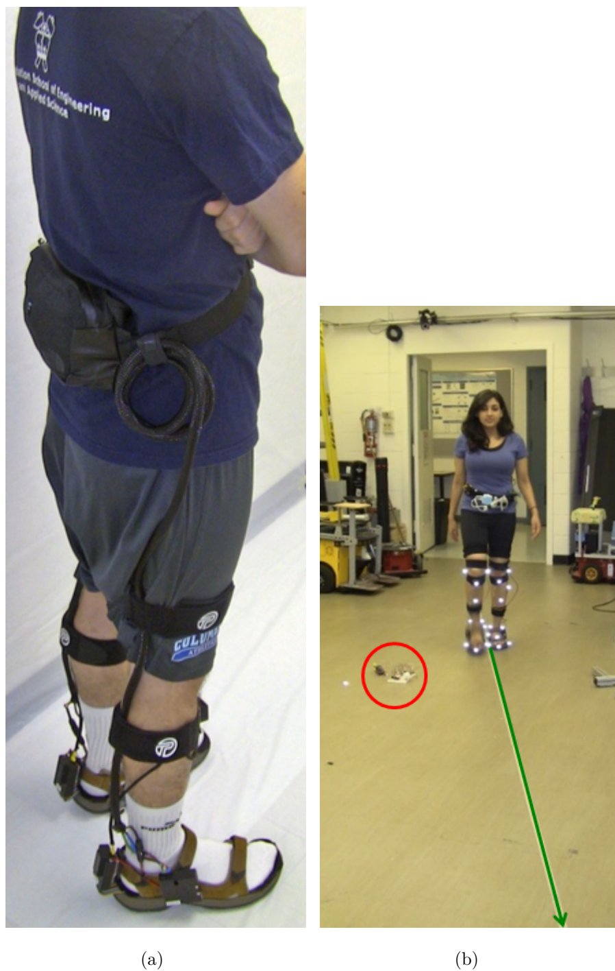
Figura 4.8: (a) Soggetto mentre indossa il prototipo SoleSound. (b) Soggetto durante un esperimento di validazione: la linea verde rappresenta il percorso effettuato, il cerchio rosso il dispositivo di sincronismo tra SoleSound e VICON
