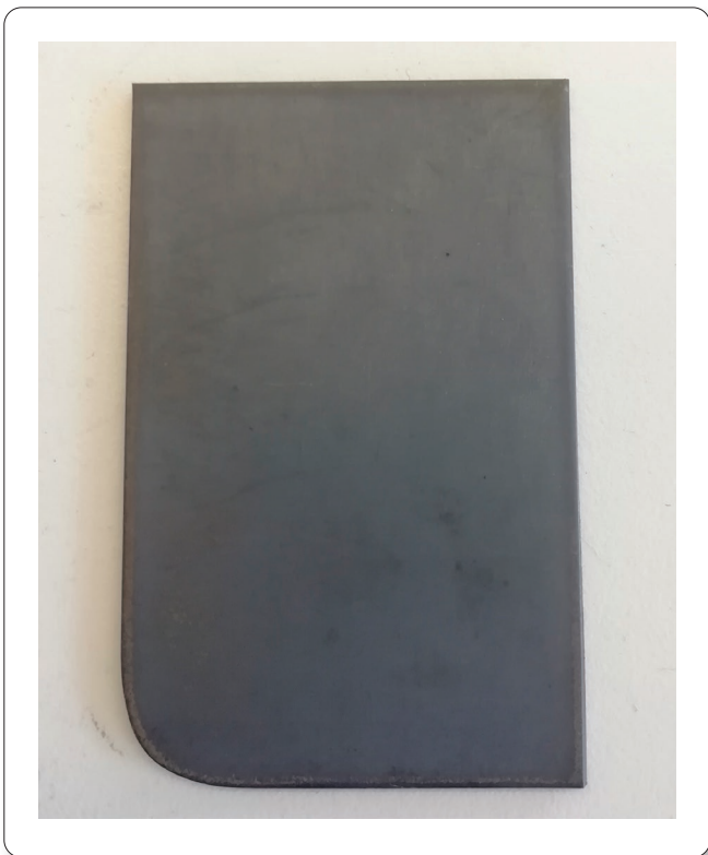
Figura 1 - Immagine della superficie brunita a livello macroscopico
