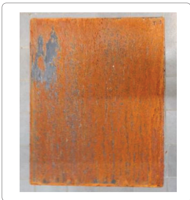
Figura 6 - Immagine del campione di acciaio inossidabile brunito dopo 250 ore di test NSS
