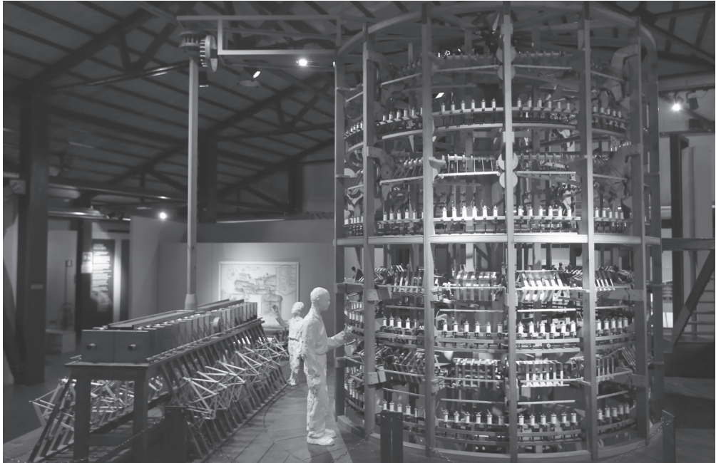
Fig. 5 - Filatoio alla bolognese con a destra l'incannatoio, sviluppato nella città emiliana verso la fine del XIII secolo - ricostruzione in scala 1:2 conservata nel Museo del Patrimonio Industriale di Bologna (mg).contatti tra Cinesi e Parti (Public domain – Wikimedia Commons).
