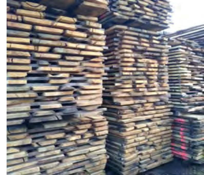
Figura 3. Stagionatura di segati si spessore 40 mm ottenuti dai tronchi oggetto di campionamento.
