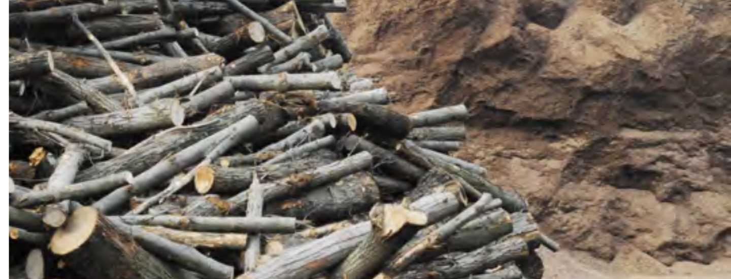
Figura 5. Legname di castagno per l'estrazione del tannino e sullo sfondo i residui del processo, destinati alla produzione di pellet.
