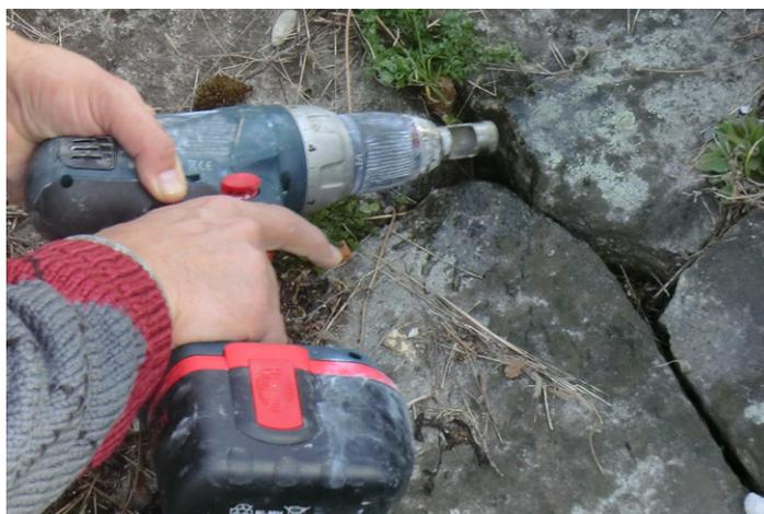
Fig. 27 – Aquileia (UD), porto fluviale. Campionamento di una delle rampe per la discesa alla Natissa (foto autore, marzo 2013).
