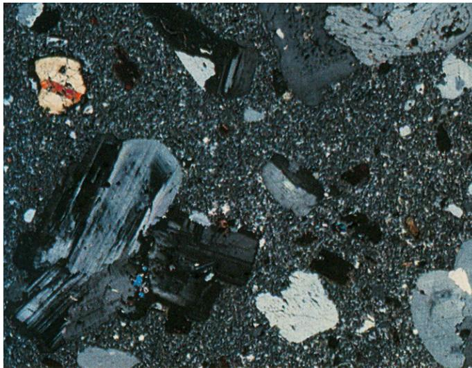
Fig. 6 – Trachite di Zovon, sezione sottile. Si osserva la struttura porfirica con prevalenza di fenocristalli di feldspato di potassio e massa di fondo microcristallina (ASTOLFI, COLOMBARA 2003, fig. 41, p. 43).
