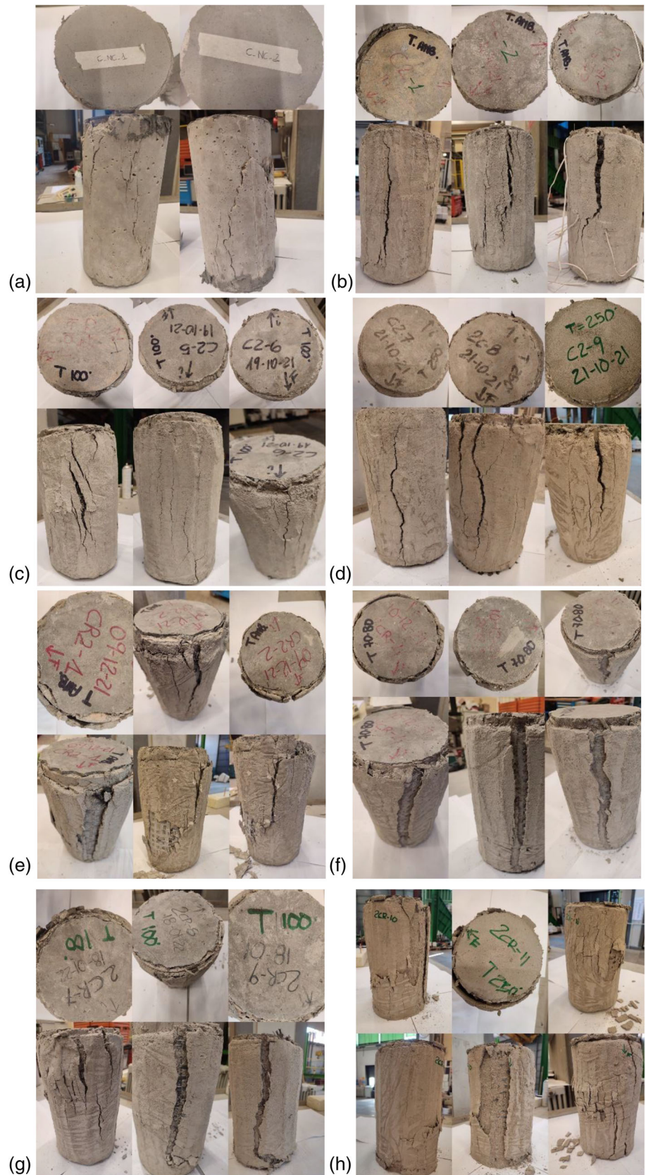
FIGURE 10 Failure modes: (a) NC, (b) C_Dry_20, (c) C_Dry_100, (d) C_Dry_250, (e) C_ER_20, (f) C_ER_80, (g) C_ER_100, and (h) C_ER_250.
