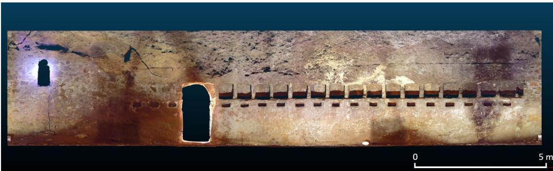
**Figura 4.23.** Ortofoto derivata dallo sviluppo cilindrico della nuvola di punti della *tholos* (*CloudCompare*).
