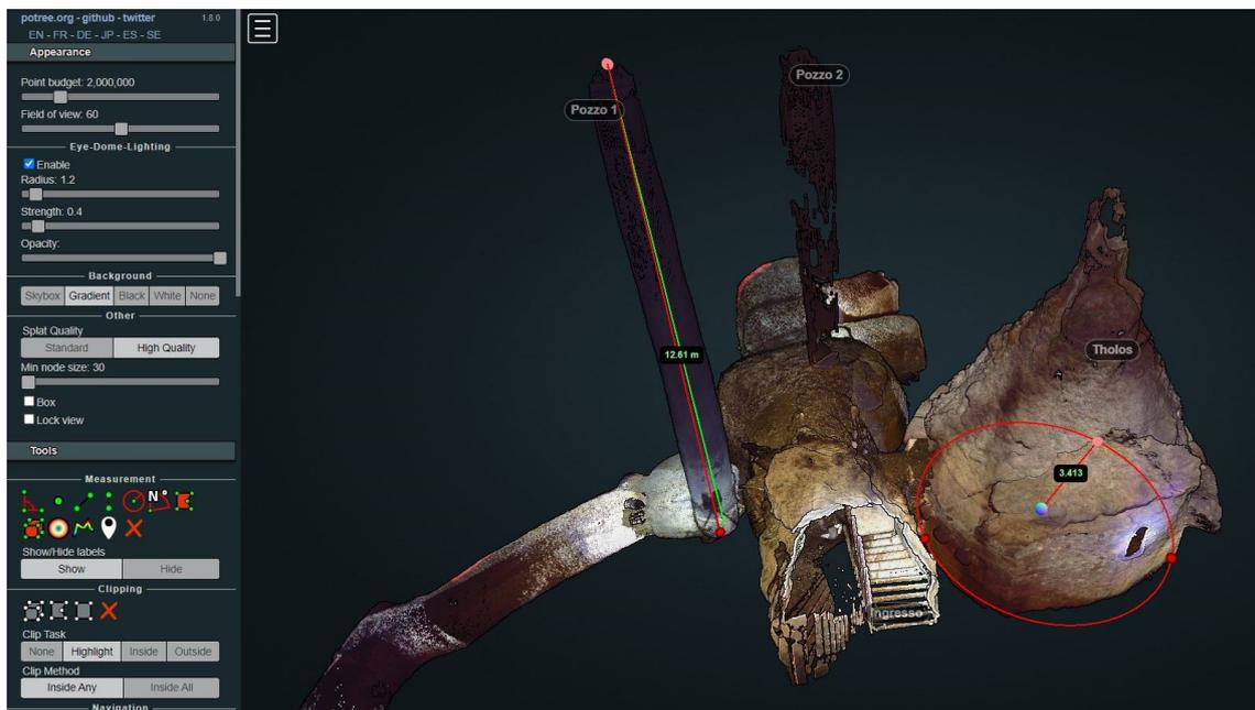
**Figura 4.25.** L'interfaccia di visualizzazione e editing di *Potree*, che permette la condivisione online di nuvole di punti di grandi dimensioni e l'esecuzione di alcune basilari ma utili analisi geometriche.
