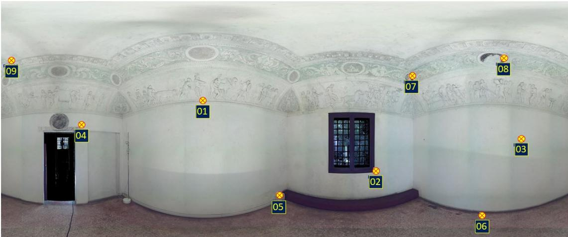
**Figura 5.7.** Vista panoramica della scansione centrale con i GCP selezionati per l'elaborazione fotogrammetrica (*Faro Scene*).
