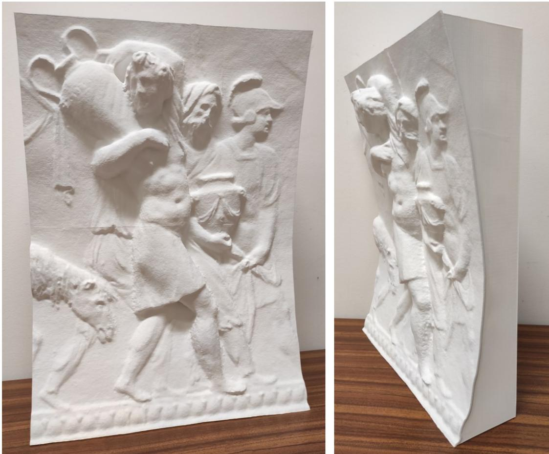
**Figura 5.26.** Il risultato della stampa 3D, con tecnologia SLS in polvere sinterizzata di PA12.
