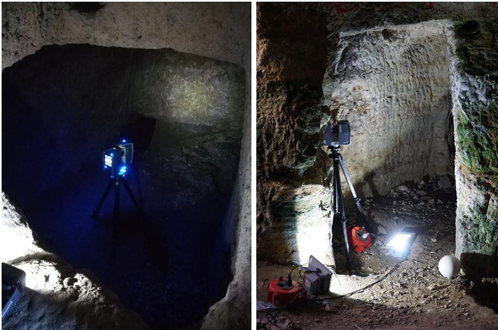
**Figura 4.7.** Due momenti dell'acquisizione TLS: la scansione del vano S7 (sinistra) e la scansione sotto il pozzo P1, all'imbocco del cunicolo S10 (destra).
