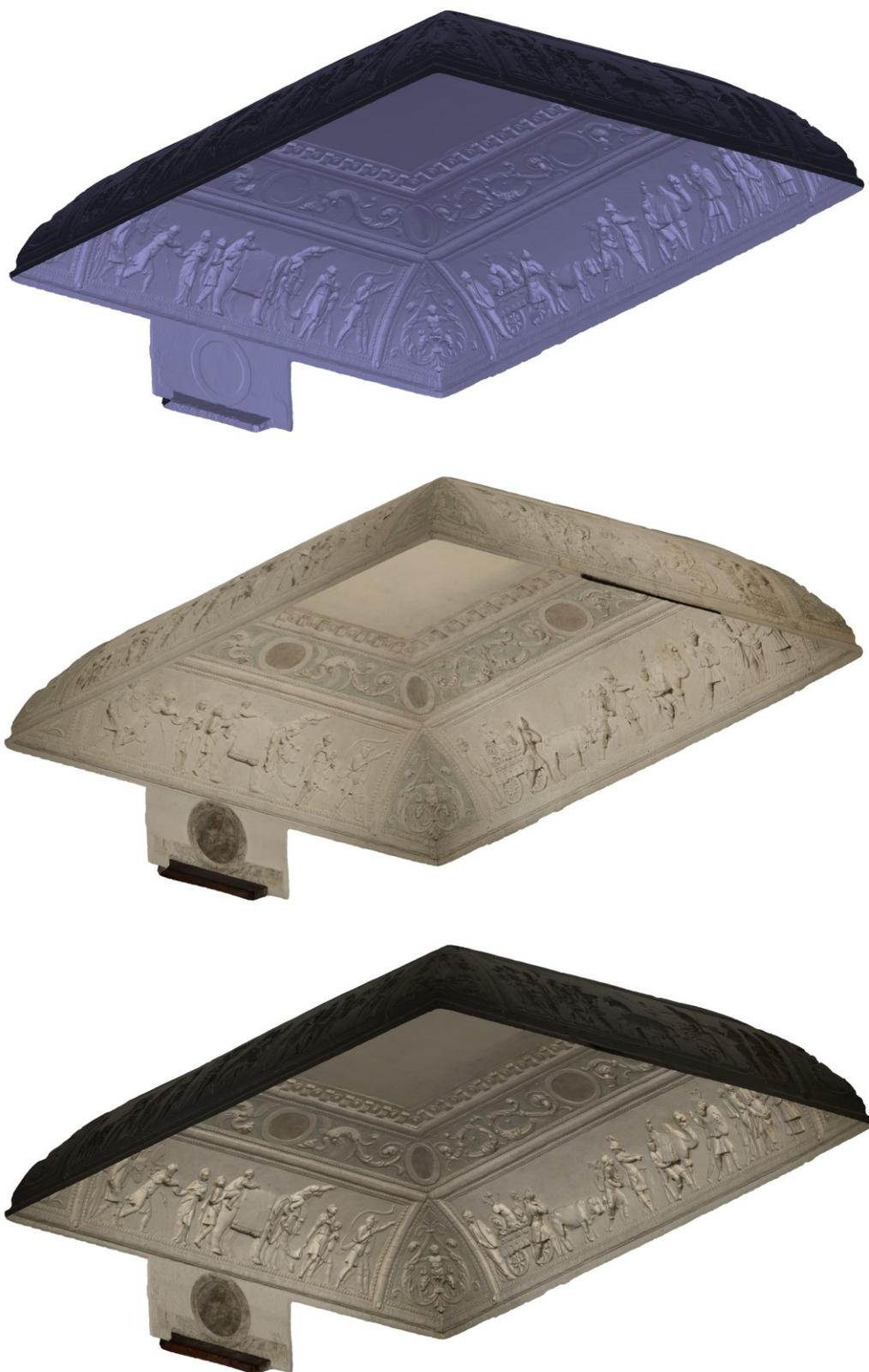
**Figura 5.11.** Modello a mesh della volta della sala del trionfo. Dall'alto: con solid texture, con texture fotorealistica, con texture shaded (*Agisoft Metashape*).
