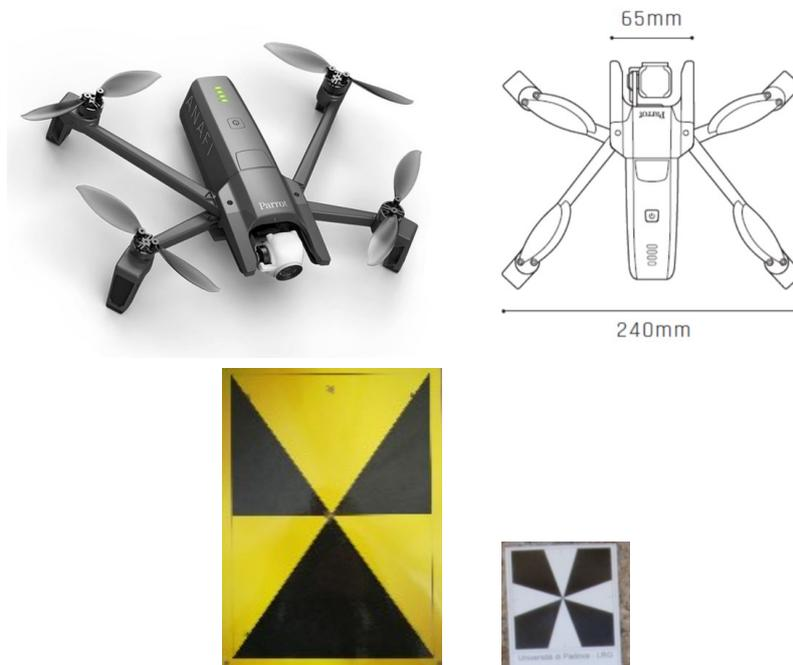
**Figura 2.6.** Drone Parrot Anafi, impiegato nel rilievo aerofotogrammetrico, e le due tipologie di marker utilizzate, per le immagini aeree e da terra.
