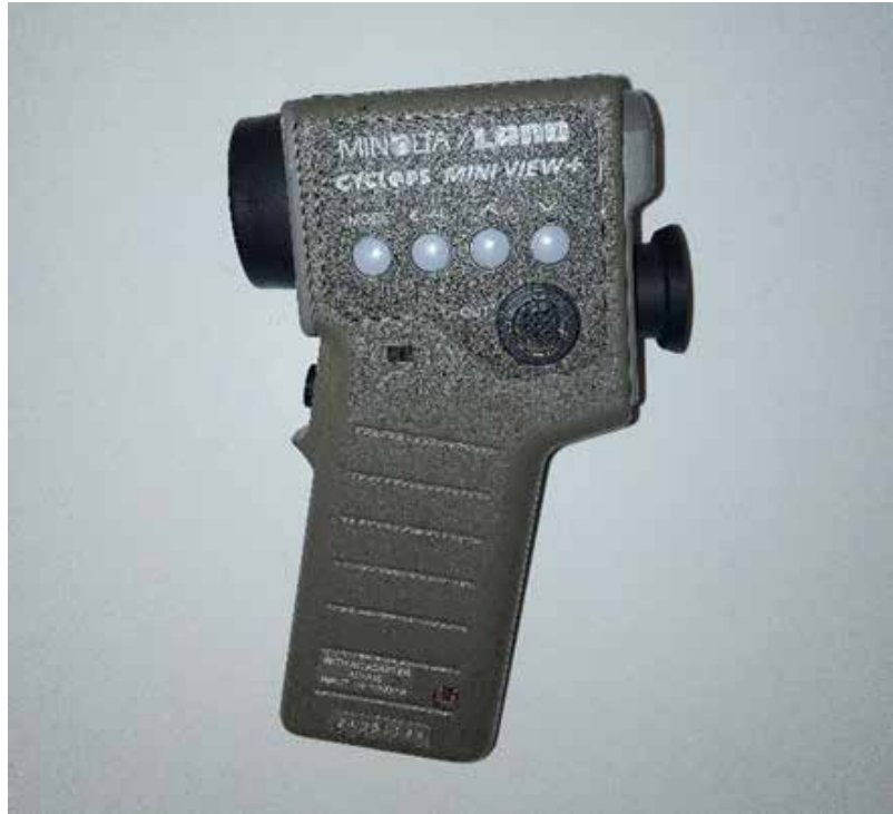
Figura 6.11. Termometro a infrarossi portatile per analizzare la temperatura fogliare (foto: Simone Cantamessa)
