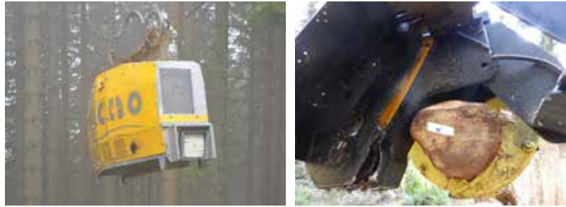
Figura 9.5. Il progetto europeo SLOPE ha sviluppato prototipi di macchine intelligenti per la tracciabilità dei prodotti legnosi: a sinistra, gru a cavo equipaggiata con antenna UHF RFID; a destra, processore sensorizzato (notare l'antenna bianca in alto e l'etichetta RFID appena affissa sul tronco dal sistema automatico) (foto: Gianni Picchi)
