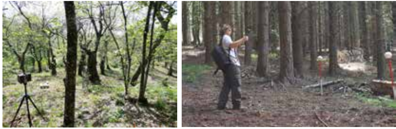
Figure 3.12. Esempi di Terrestrial Laser Scanner (TLS) : a sinistra TLS fisso e a destra TLS Portatile (PLS) (immagini: Pietro Castellucci, Nicola Puletti, Francesca Giannetti e Elena Marra)
