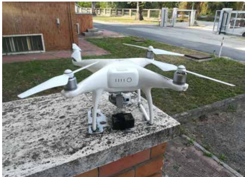
Figura 6.12. Aereomobile a pilotaggio remoto (drone) con sensore per rilevare l'indice NDVI (foto: Pier Mario Chiarabaglio)
