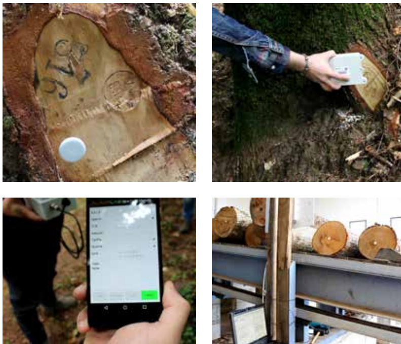
Figura 9.7. Tag RFID a chiodo (bianco) inserito vicino alla specchiatura con la martellata; lettura del tag tramite antenna; trasmissione delle informazioni del tag e inserimento dati tramite App specifica sulla piattaforma di infotracing ; topi con tag RFID UHF letti dall'antenna industriale in segheria (foto: Corrado Costa)
