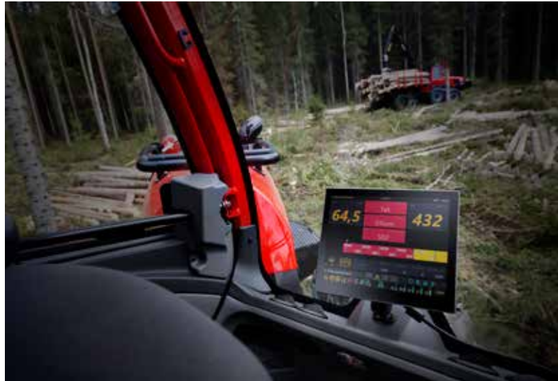
Figura 8.8. Schermata display di una macchina operatrice combinata per la visualizzazione in tempo reale di informazioni raccolte dai sensori installati (fonte: https://www.komatsuforest.co.uk/forest-machines )
