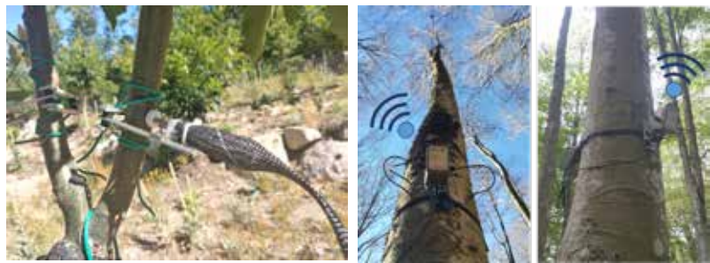
Figura 3.2. Esempio di strumenti che utilizzano l’approccio dell’ Internet of Things and Services (IoT) in ambito forestale: dendrometro (sinistra - foto: Claudia Coccozza) e tree talker (centro e destra - foto: Ilaria Zorzi)
