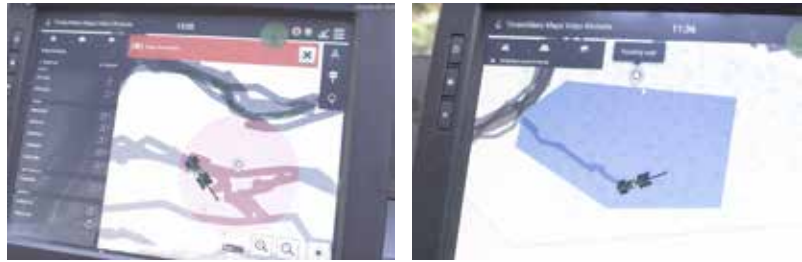
Figura 8.11. Visualizzazione sul display della macchina delle aree a rischio per pendenza eccessiva del terreno (sinistra) o per scarsa portanza del suolo (destra) (fonte: TimberMatic Maps)
