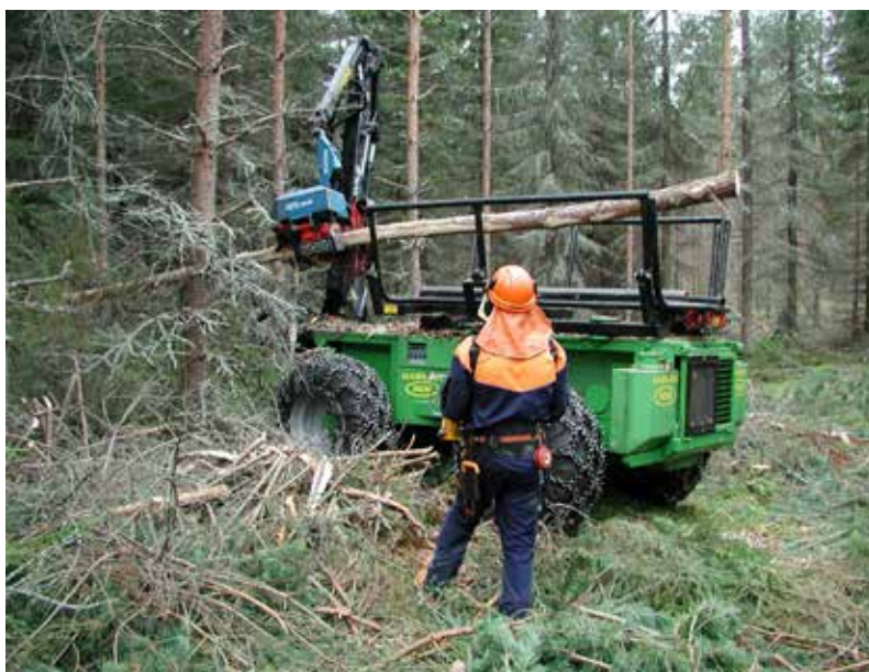
Figura 8.37. Macchina abbattitrice controllata a distanza utilizzata in diradamenti (fonte: Jelavic et al. 2021)
