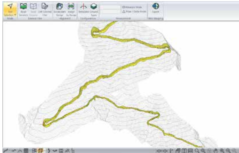
Figura 5.20. Progetto di strada forestale basato sull'impiego di software specifici (immagine: Stefano Grigolato)
