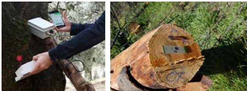
Figura 9.4. Esempio di lettore RFID a basso costo, basato su Arduino (sinistra - foto: Costa Corrado) e di etichette elettroniche applicate su tronchi esboscati (nell'immagine a destra, l'etichetta bianca è una comune etichetta commerciale adattata, mentre l'etichetta con antenne rosse è un prototipo specifico per la filiera foresta-legno) (foto: Gianni Picchi)
