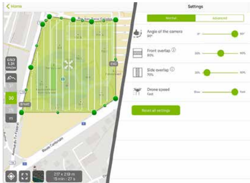
Figura 8.26. Immagine raffigurante l'applicazione PIX4Dcapture® con cui è possibile pianificare il volo del drone per stimare i danni presenti dopo il passaggio dei mezzi forestali (fonte: PIX4Dcapture®)
