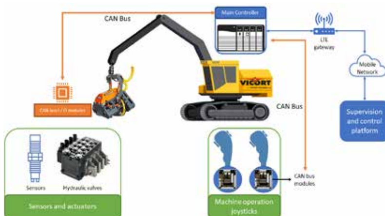
Figura 8.4. Esempio grafico di connessioni CAN bus di un escavatore cingolato equipaggiato con processore (fonte: Spencer et al. 2021)
