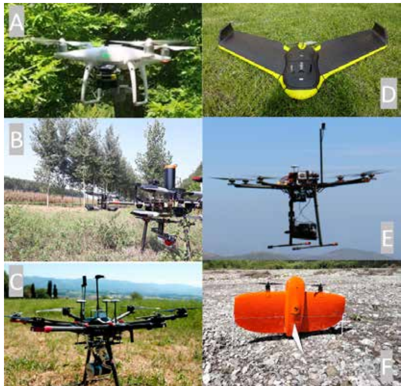
Figura 5.5. Esempi di UAV. A: drone multicottero con sensore multispettrale e RGB a basso costo, B: drone multicottero con sensore multispettrale, C: drone multicottero con sensore LiDAR a terra, D: drone ad ala fissa con sensore RGB e multispettrale, E: drone multicottero con sensore LiDAR in volo, F: drone ad ala fissa con decollo verticale con sensore RGB e multispettrale (immagini: Francesca Giannetti)
