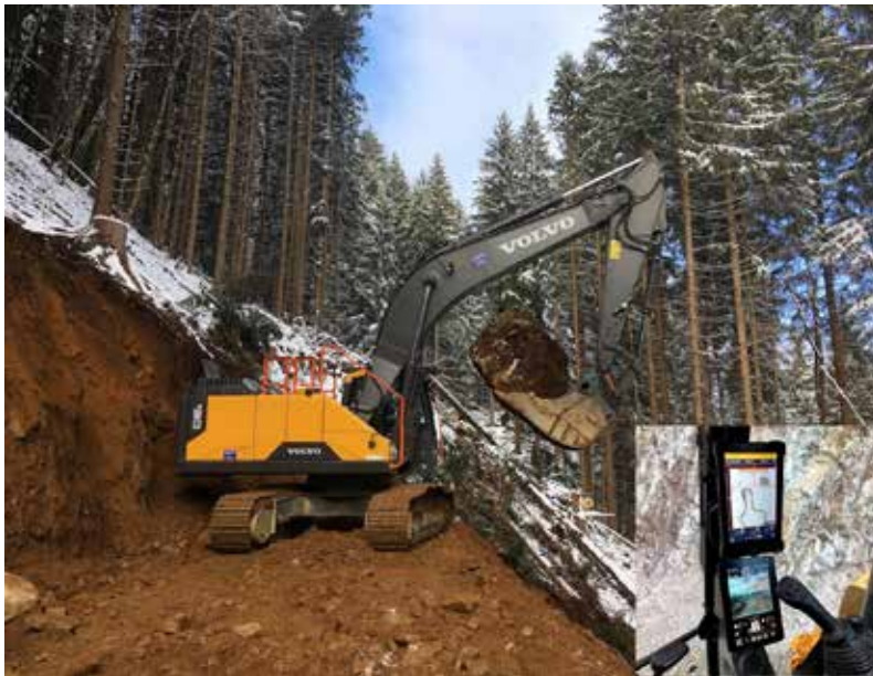
Figura 5.21. Escavatore equipaggiato di sistema di posizionamento e sistemi di visualizzazione degli elaborati georeferenziati (immagine: Stefano Grigolato)
