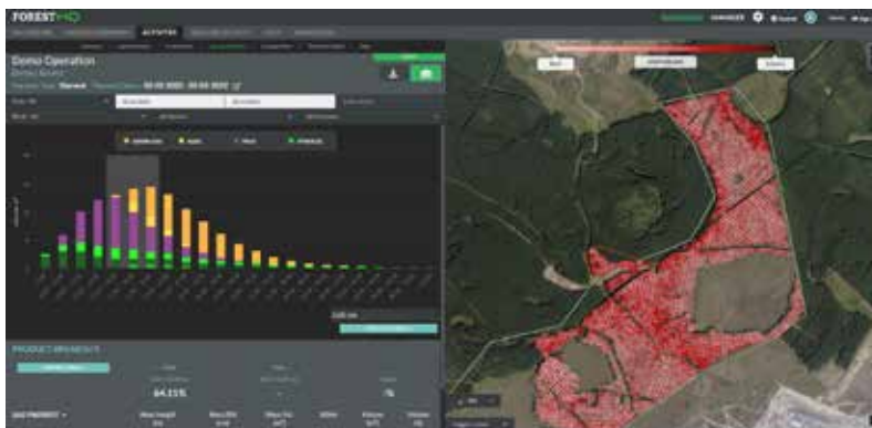
Figura 8.10. Dati volumetrici di ogni singola pianta abbattuta nell'area di lavoro (immagine a destra, area sottoposta ad utilizzazione forestale delimitata in verde con alberi abbattuti indicati con cerchio rosso, colorazione crescente all'aumentare del volume legnoso misurato con i sensori presenti sulla macchina abbattitrice/allestitrice). L'operatore può visualizzare in tempo reale la ripartizione degli assortimenti a seconda dell'utilizzo finale e del volume (immagine a sinistra, legname classificato in legname da: green log - paleria, bars - tavole, pulp - cartiera, other - altro) (fonte: Tre-emetrics - FORESTHQ)
