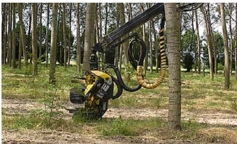
Figura 6.5. Testa harvester in grado di abbattere, sramare, misurare e sezionare i fusti arborei e accatastare i topi (foto: Pier Mario Chiarabaglio)
