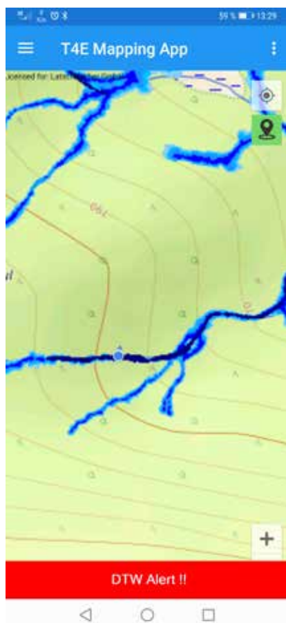
Figura 8.29. T4E Mapping App che fornisce un avviso visivo e sonoro all'operatore che con il proprio mezzo (rappresentato dall'indicatore blu) si trova in una zona soggetta a rischio (intensità maggiore di blu rappresenta un maggior rischio) (fonte: Latschbacher GmbH - www.latschbacher.com )
