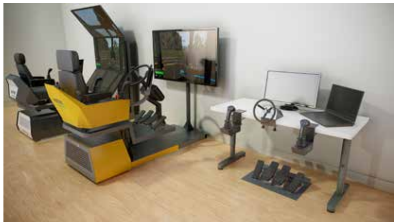
Figura 8.30. Tipologie di postazioni utilizzate per la simulazione di macchine forestali (fonte: per gentile concessione di CM Labs Simulations, Inc. - https://www.cm-labs.com/immersive-simulation-products/forestry-equipment-training-simulators/harvester/ )
