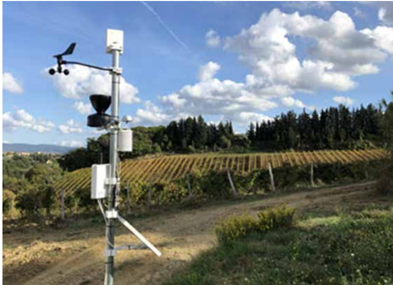
Figura 6.14. Stazione meteo per la rilevazione meteorologica e climatica (fonte: per gentile concessione della ditta Netsens S.r.l.)
