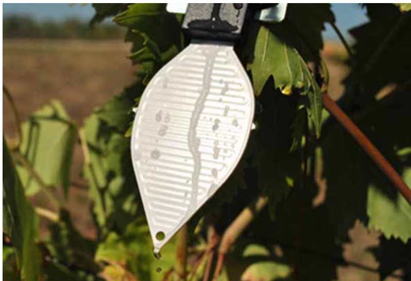
Figura 6.15. Sensore di bagnatura fogliare (fonte: per gentile concessione della ditta Netsens S.r.l.)
