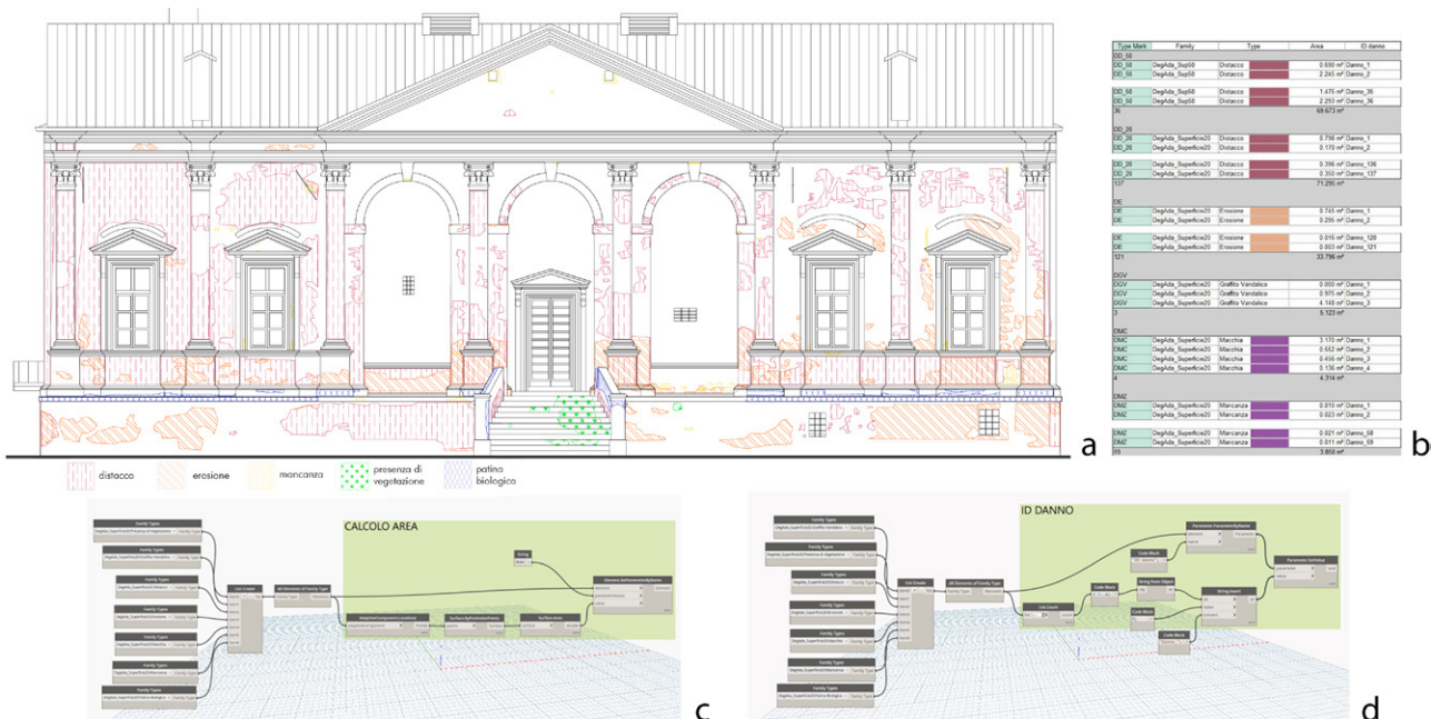
Fig. 4. Vicenza, Villa Gazzotti. Rilievo del degrado della facciata di villa Gazzotti mediante famiglie adattive di superficie: a) rappresentazione grafica; b) vista parziale dell'abaco; c) algoritmo per il calcolo dell'area; d) algoritmo per l'assegnazione dell'identificativo.
