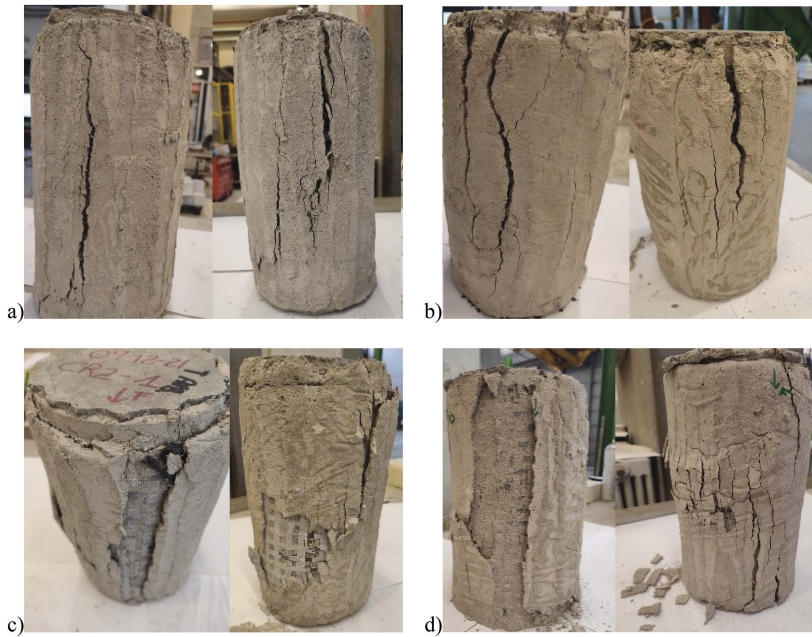
Figure 3. Final crack pattern for a) C_20_2C, b) C_250_2C, c) C_20_2CR and d) C_250_2CR.
