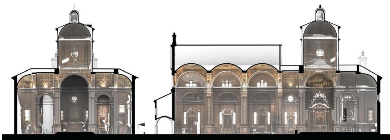
12/ Carpi, chiesa di San Nicolò, sezione trasversale e longitudinale, sovrapposizione del modello BIM alla nuvola di punti, elaborazione grafica di Federico Panarotto.
