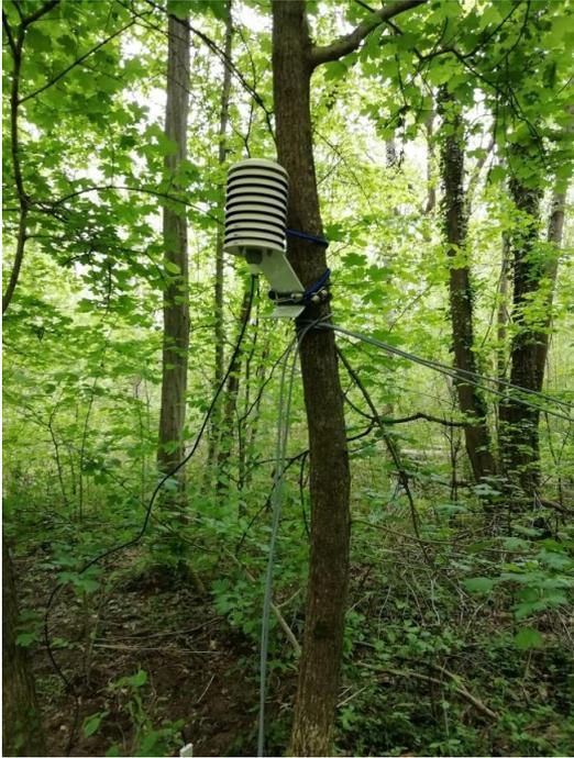
Sensore di temperatura ed umidità dell'aria
