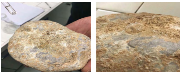
Figura 22 – Aggiunta di acido cloridrico al campione e attac-co acido del carbonato.
