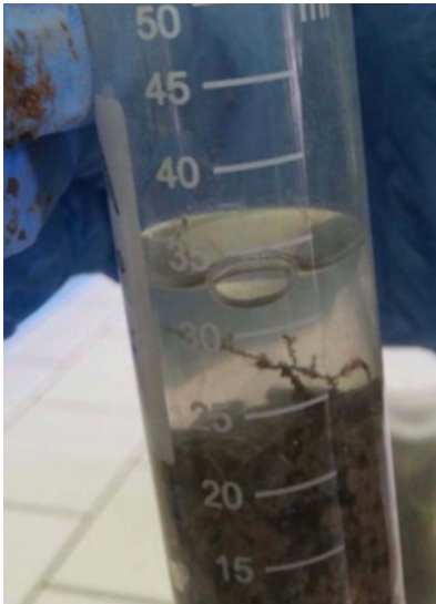
Figura 7 – Cilindro che contiene una sospensione di suolo e acqua.
