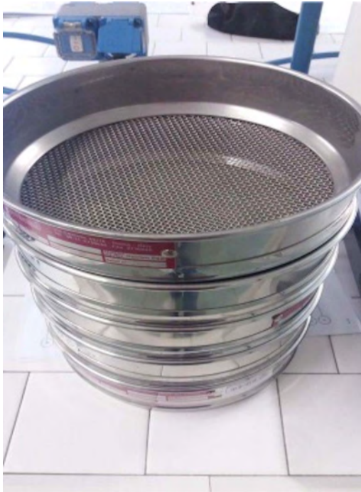
Figura 9 – Setaccio utilizzato durante la procedura.
