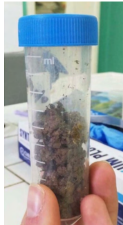
Figura 8 – Cilindro che contiene un campione di suolo per la verifica del contenuto di acqua.
