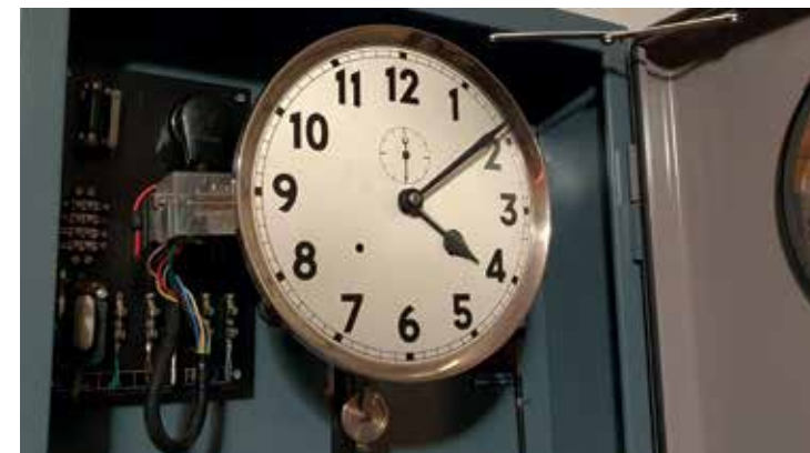
Fig.3 Orologio registratore con cassa in metallo RSI 20, fine anni '60. Dettaglio lancia impulsi. (Foto: Andrea Moro)
