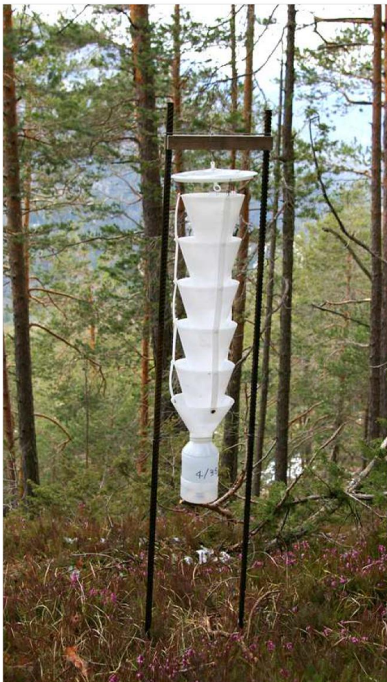
Fig. 6 - Trappola a feromoni del tipo "ad imbuto" impiegata in Cadore per il monitoraggio delle popolazioni di Ips acuminatus (foto: F. Colombari).
