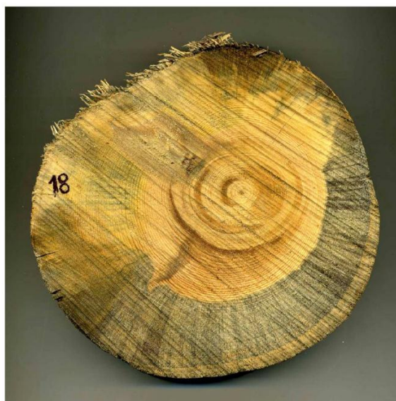
Fig. 4 - Azzurrimento dell'alburno dovuto a funghi del genere Ophiostoma inoculati dagli adulti di Ips acuminatus (foto: F. Colombari).
