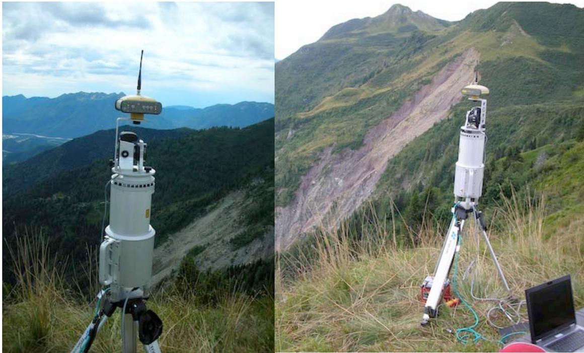
**Figura 4.6** – Riegl LMS-Z620 durante alcune fasi di un rilievo
