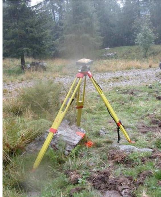
**Figura 4.15** – Stazioni GPS durante le fasi di rilievo
