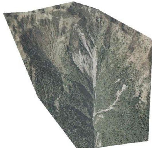
**Figura 4.4:** DTM derivato dal volo LiDAR. Oltre all'area di frana più estesa sono visibili anche zone minori sul lato destro.
