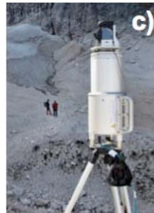
**Figura 3.24** – a) Vista 3D dell’hillshade ricavato dal DTM ottenuto mediante scansione laser. b) Collocazione dei punti di stazionamento con TLS, GPS e stazione totale. c) Il laser scanner utilizzato per il rilievo della topografia superficiale del ghiacciaio.
