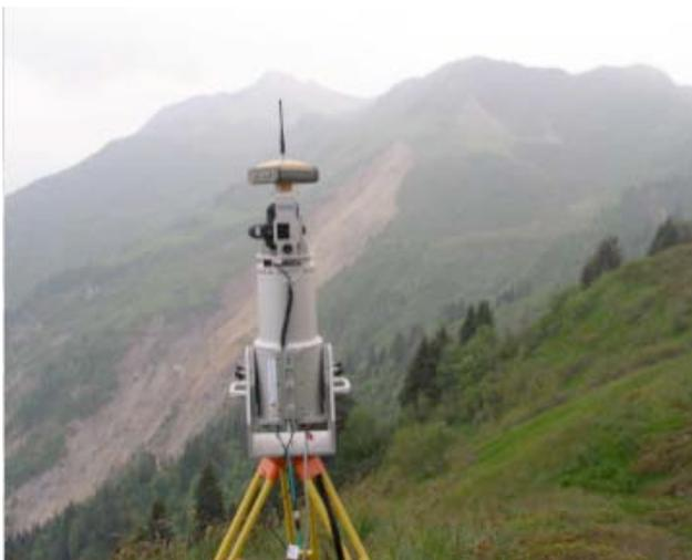
**Figura 4.18:** Riegl LMS-Z620 con fotocamera digitale e GPS Topcon in acquisizione. Sullo sfondo è visibile l'area di frana principale.
