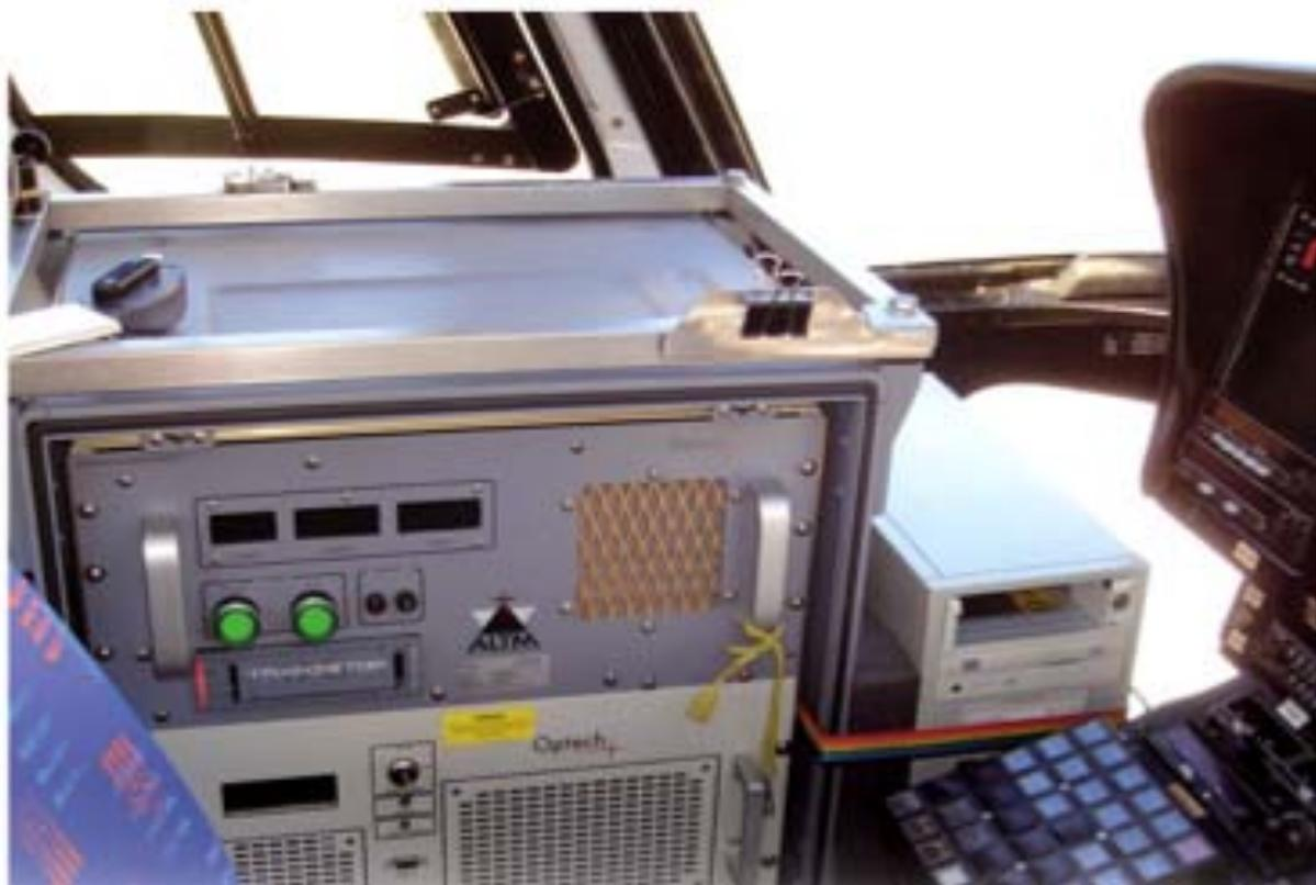
**Figura 4.1** – Caratteristiche e Componenti del sensore ALTM 3033 OPTECH installato su elicottero
