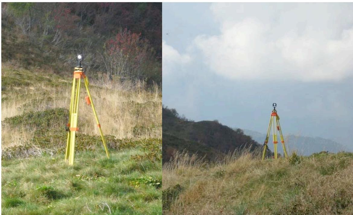
**Figura 4.20** – Target sopra ad un treppiede durante le fasi di rilievo
