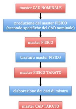
Fig. 1 Diagramma di flusso dell'esecuzione del master CAD tarato.
