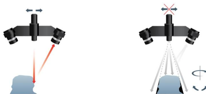
Fig. 2.11 Il principio di scansione tridimensionale. Sinistra: uno scanner laser 3D con due assi di rotazione e un asse lineare. Lo scanner laser genera una linea di luce che viene spostata lungo l'oggetto mediante gli assi lineari. Destra: uno scanner a luce bianca con due assi di rotazione. La fonte luminosa genera più linee di luce e, di conseguenza, offre una visione d'insieme da una sola posizione.
