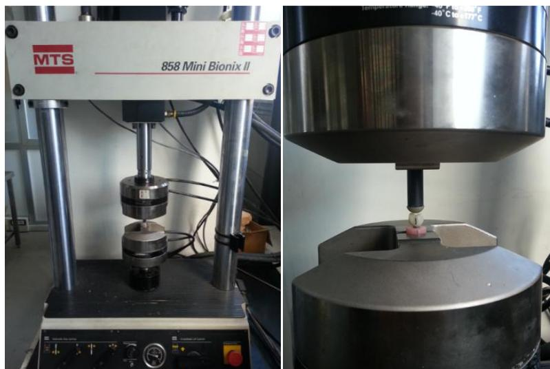
Fig. 5. Veduta della macchina per I test durante le prove ( MTS 858 Mini Bionix II )
