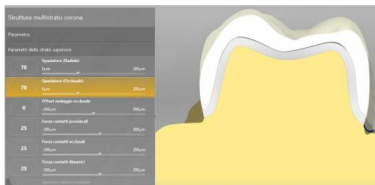
Fig. 5 Esempio di finestra di settaggio Cam del programma Inlab 15.0 per la realizzazione di una protesi Cad-on (settaggio spaziatura a 70 µm).
