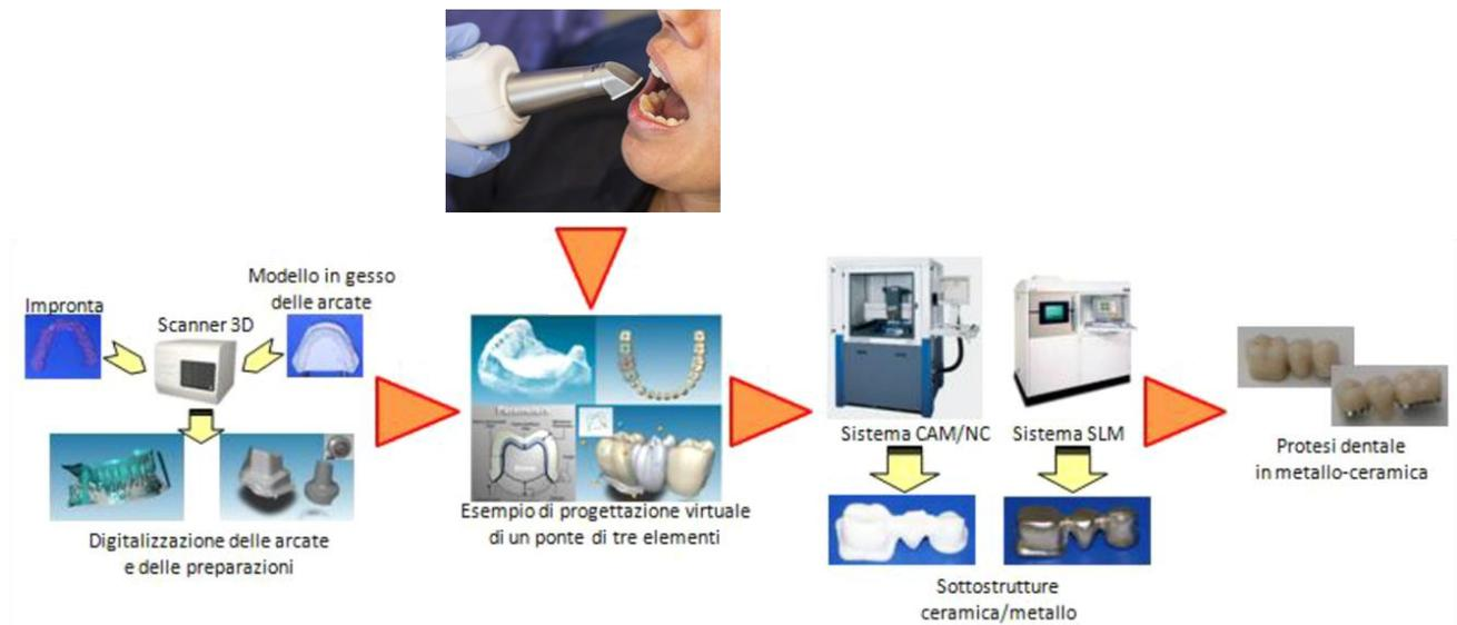
Fig. 2.10 Fasi del processo Cad-Cam per la realizzazione di una protesi fissa multilayer in metallo-ceramica.
