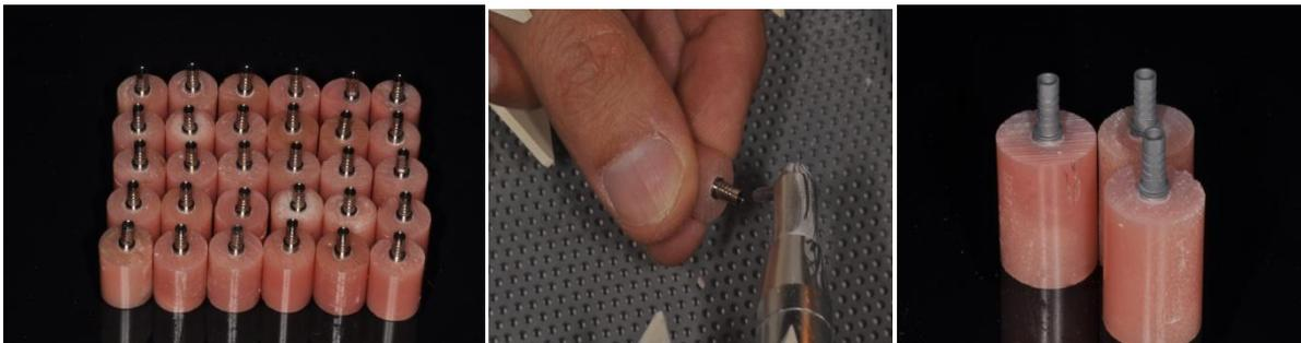
Fig. 1: a sinistra, i campioni prima della cementazione; al centro, la sabbiatura dei pilastri; sulla destra, aspetto dei pilastri in titanio dopo la sabbiatura.
