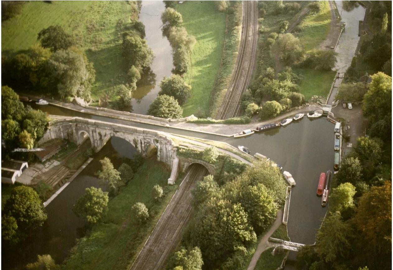
*Figura 15 - Foto dall'alto del Dundas Aqueduct. Si può notare l'eleganza del ponte ma soprattutto la sua larghezza grazie alle barche in fila nel bacino d'entrata, tra cui alcune tipiche Narrow Boats. A sinistra si vede il corso naturale del fiume Avon, mentre in alto a destra si può osservare il Somerset Coal Canal che si unisce al Kennet & Avon (Fonte: Kennet and Avon Canal Trust Archive)*
