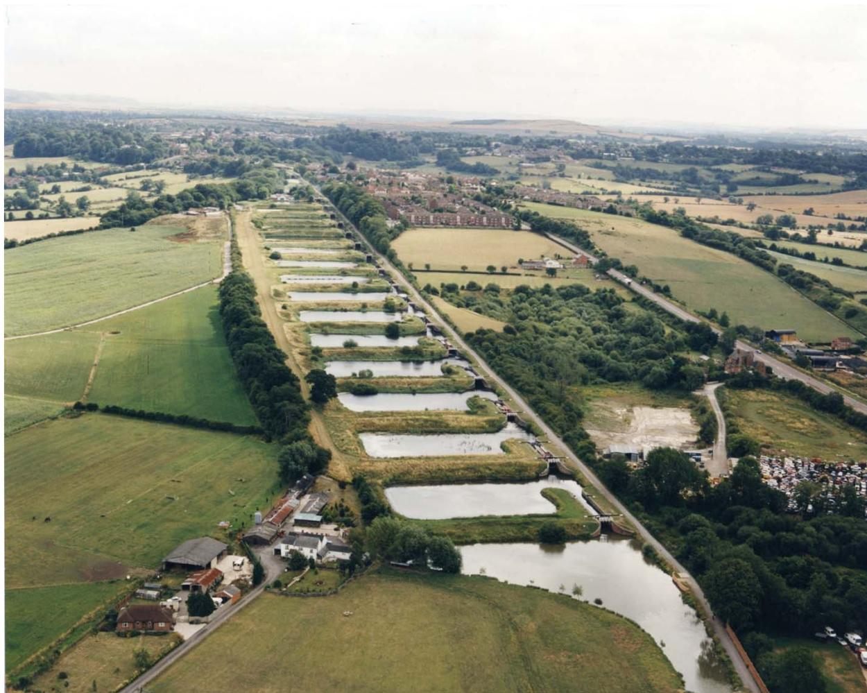
*Figura 16 - Le Caen Hill Locks in una foto aerea degli anni novanta. Si possono notare le vasche d'acqua a fianco delle chiuse per garantire il continuo ricambio d'acqua all'interno delle sezioni (Fonte: Kennet and Avon Canal Trust Archive)*
