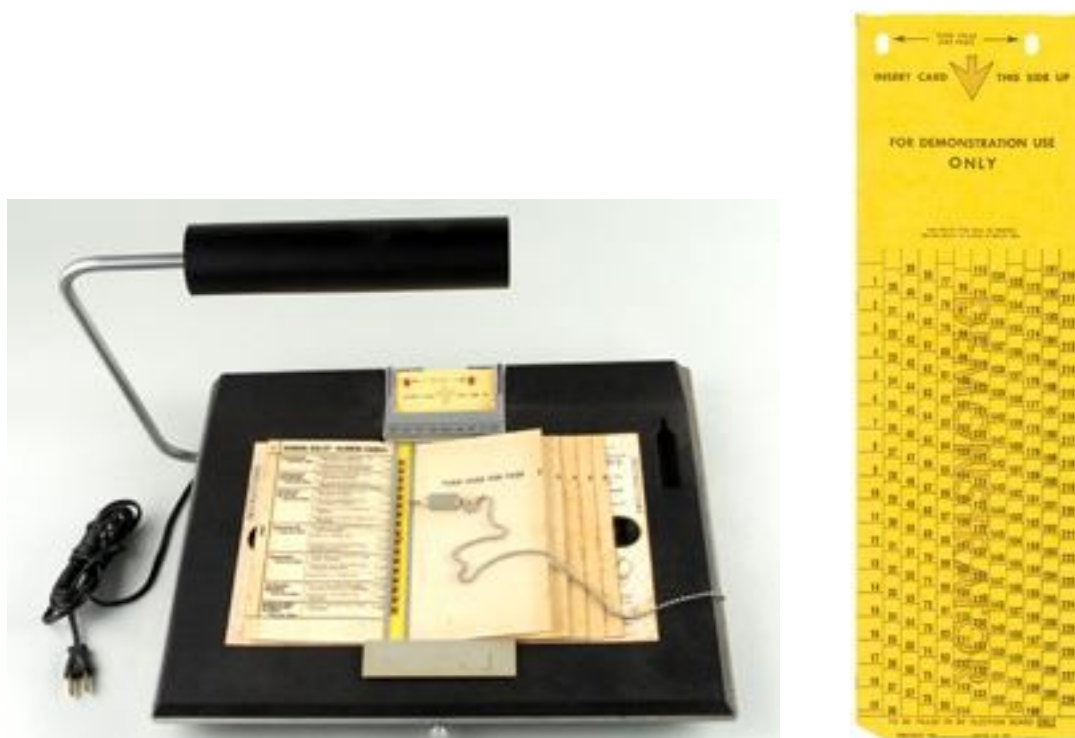
Figura 3 – Sistema di voto a scheda perforata “Votomatic” e scheda perforata
